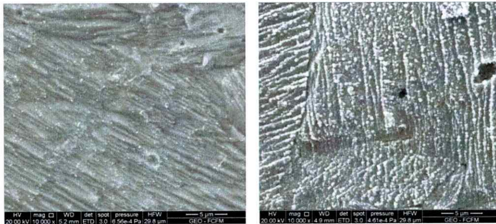
Figura 12. Microfotografía de la superficie de cobre tratada con ácido nítrico y recubierta con una solución de nitrato de plata 1 mM (izquierda) y 17 mM (derecha).
