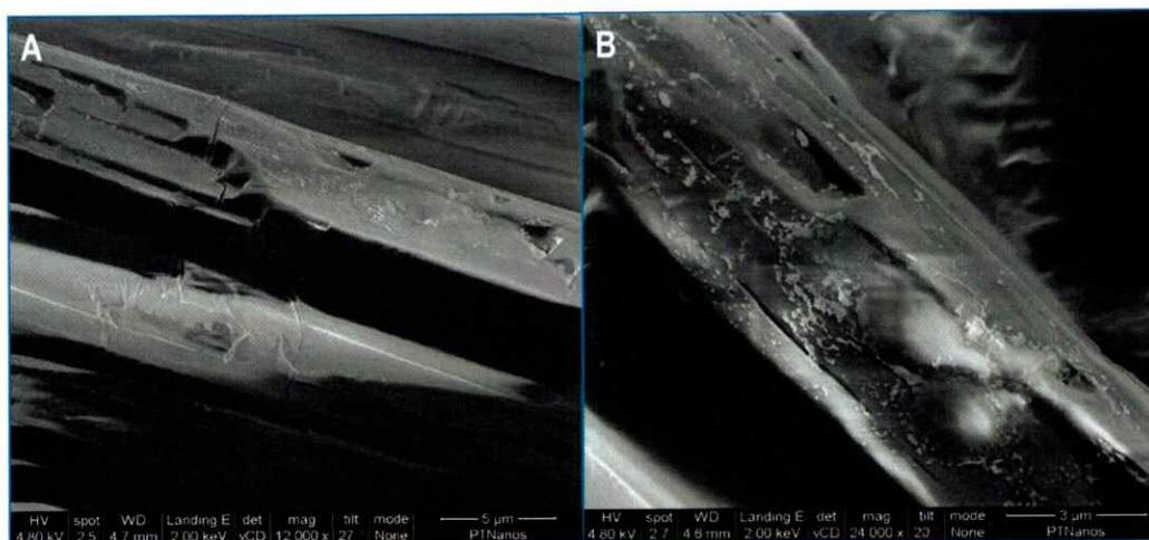
**Figura 5.14.** A) y B) Micrografías SEM que muestran la nanodecoración selectiva de cristales de  $\alpha$ -CD/DDT con NPsAu.
