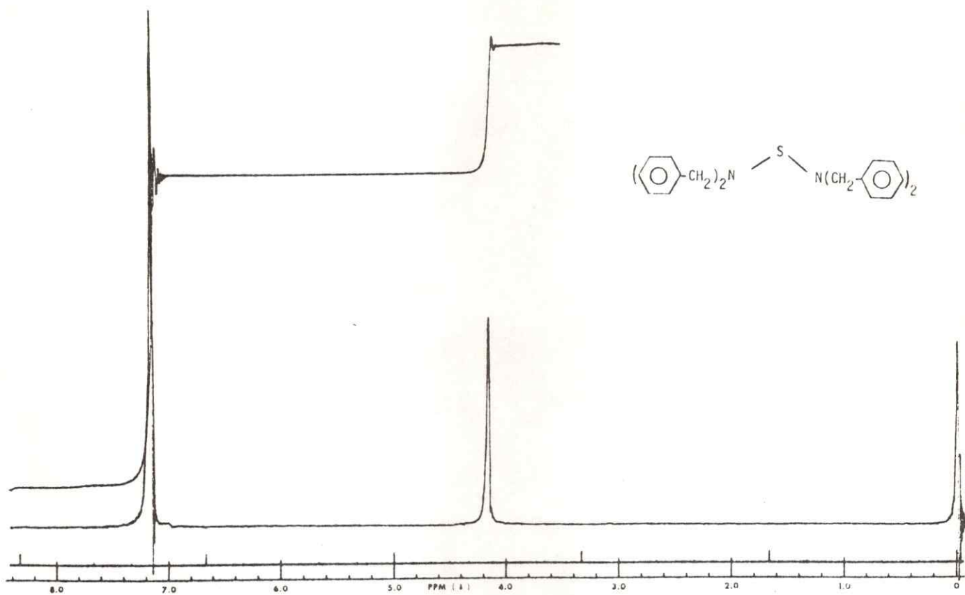
Figura 2 Espectro de Resonancia Magnética Nuclear Protónica de la N,N'-tiobisdibencilamina y de la N,N'-tiobisdialilamina (en \text{CCl}_4 , usando TMS como referencia interna).
