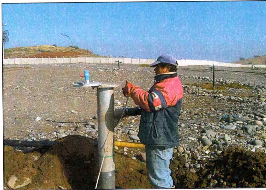
Figura 4. Pozos de captación de biogás, para toma de muestras de lixiviado en ex vertedero Lepanto.
