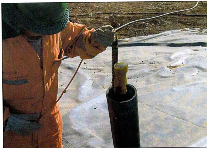
Figura 4. Pozos de captación de biogás, para toma de muestras de lixiviado en ex vertedero Lepanto.
