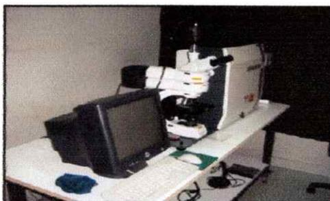
*Figura 16. Espectrómetro Raman Renishaw microscope system RM1000 equipado con un microscopio Leica.*
