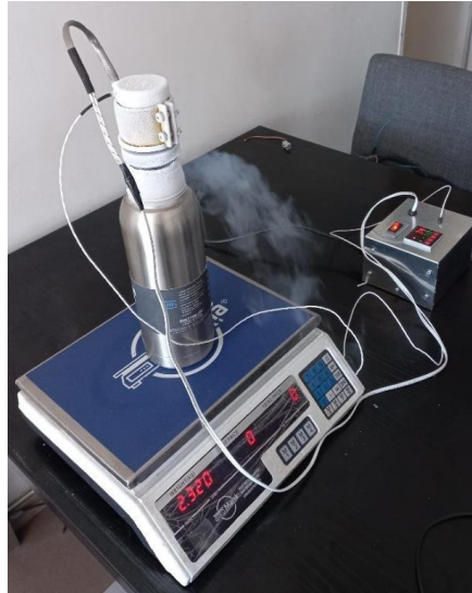
Figura 17: Equipo de freeze casting en funcionamiento, incluyendo componentes mecánicos y sistema de control eléctrico.
