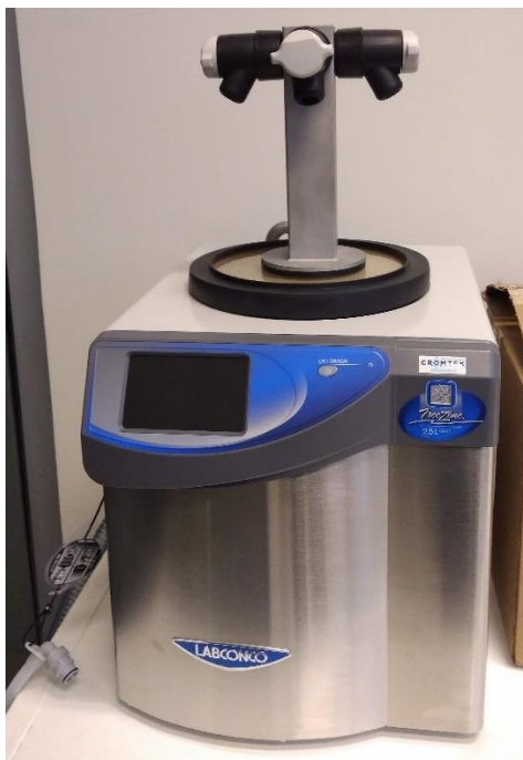
Figura 10: Equipo de liofilización (Freeze-Drying) Labconco FreeZone de 2.5 litros de sobremesa
