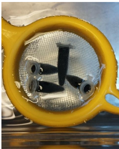
Figura 44: Viales puestos en baño ultrasónico para desaireación.
