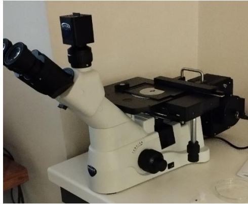
Figura 29: Microscopio óptico compuesto modelo IM-3MET, Optika.
