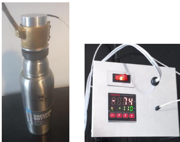
Figura 18: Izq. Sistema mecánico con sensor y actuador eléctrico. Der. Sistema controlador eléctrico.
