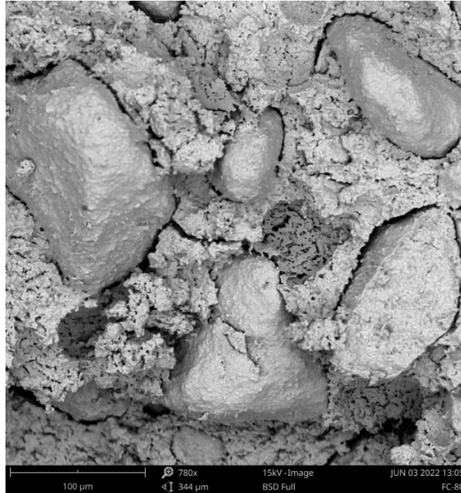
Figura 30: Primera muestra blanco a -80°C. Corte axial sin estructura y presencia de granos. Se requiere dispersante.
