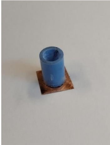
Figura 22: Molde plástico armado con placa base metálica de cobre 0.5 mm.
