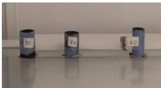
Figura 47: Muestras post freeze casting mantenidas en congelación.
