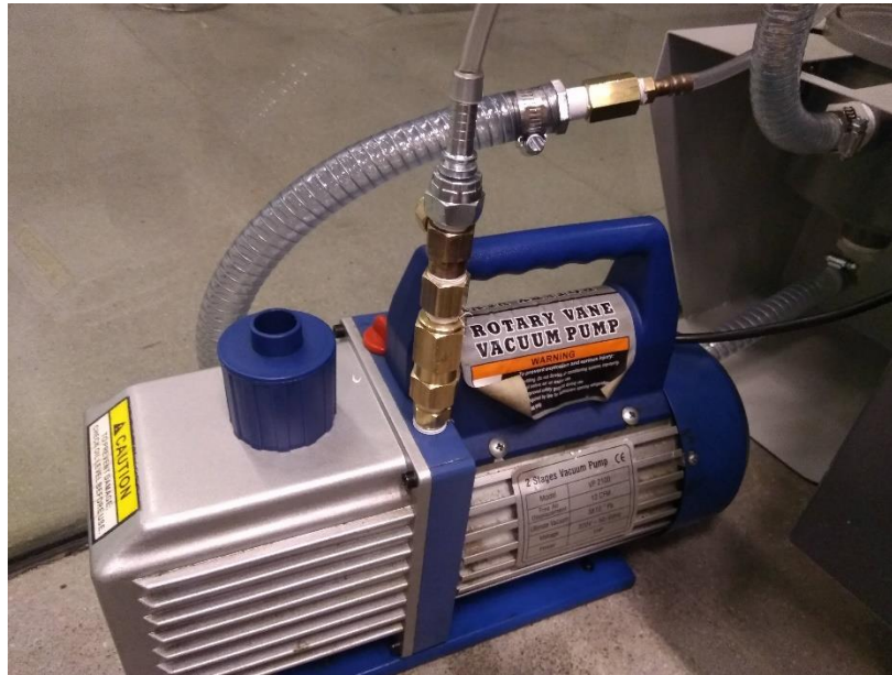
Figura 11: Bomba de vacío VP2100 de 1HP con conexiones compradas.
