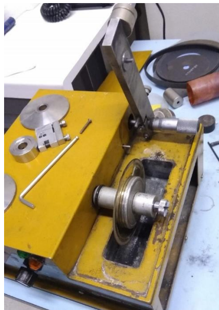
Figura 28: Cortador de precisión de baja velocidad con disco diamantado.
