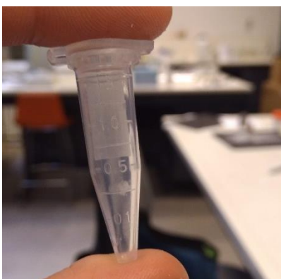
Figura 23: Vial de 1.5 mL utilizado para llevar la mezcla antes de pasar al molde.
