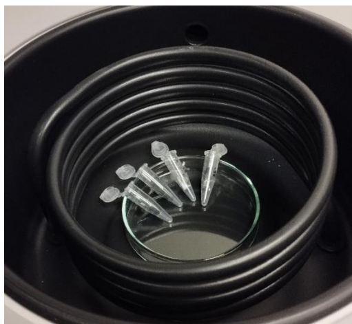
Figura 49: Muestras en viales puestos en cámara de vacío a baja temperatura.
