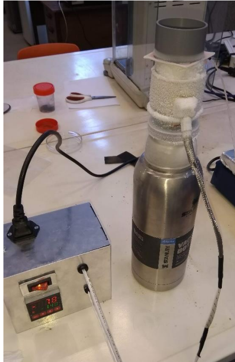
Figura 20: Primer testeo de equipo de freeze casting con carga.
