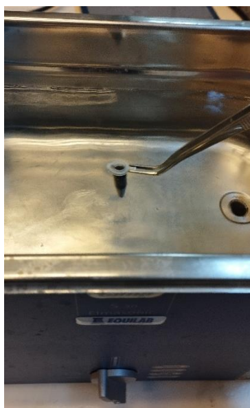
Figura 24: Vial de 1.5 mL en baño ultrasónico para eliminar aire de la mezcla.
