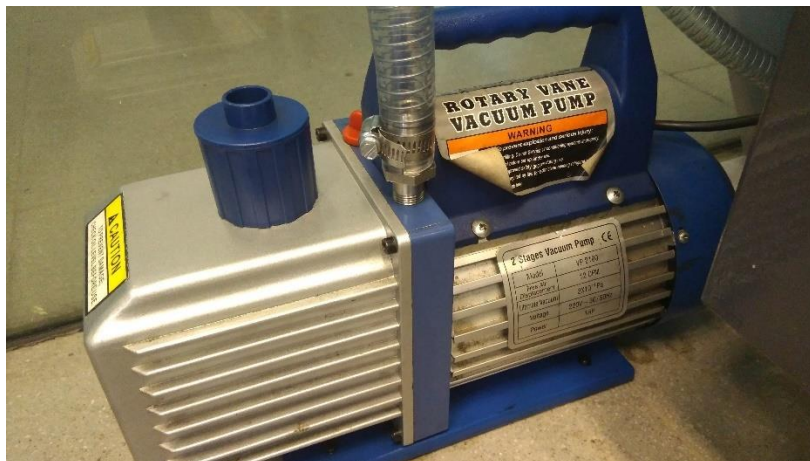
Figura 12: Bomba de vacío con conexión manufacturada en taller mecánico.
