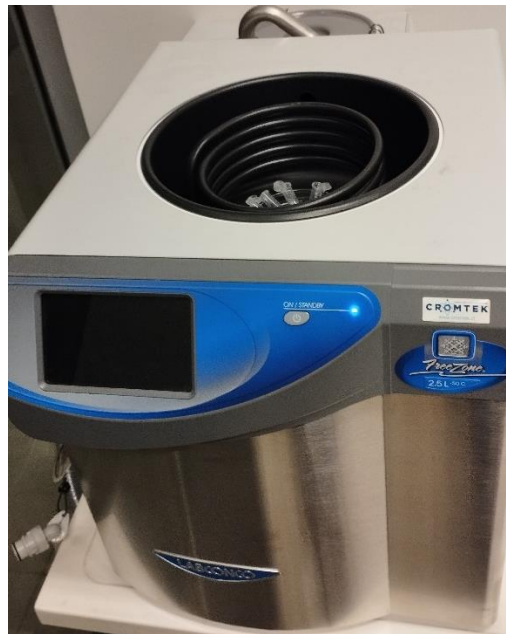
Figura 26: Liofilizador FreeZone 2.5L cargado con viales.
