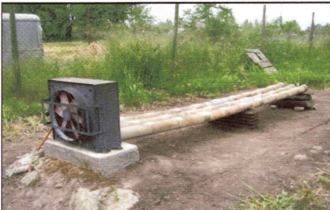
Figura 6. Sistema de aireación forzada
