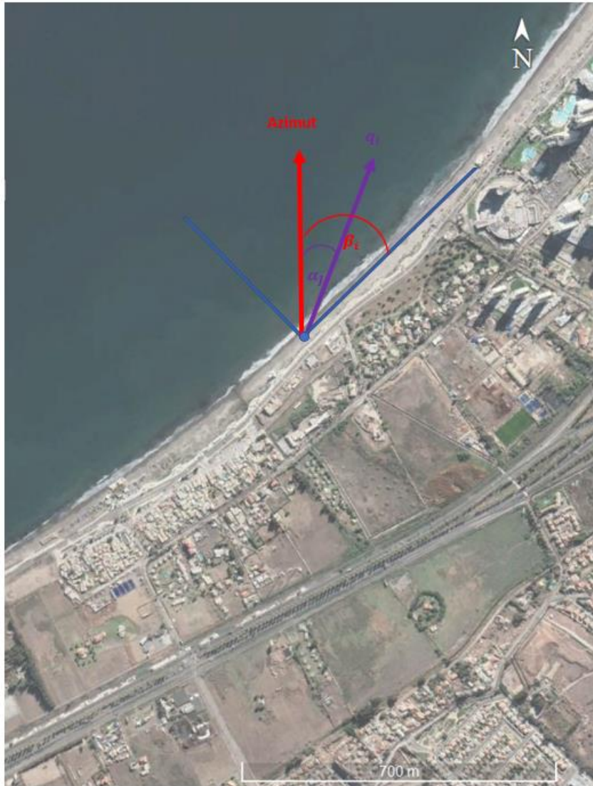
Figura 16: Esquema de cálculo trigonométrico de transporte eólico.
