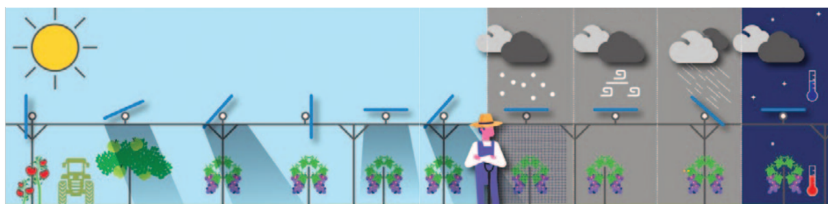
Figura 4.5: Tecnología de seguimiento solar en sistemas Agrivoltaicos. [43].
