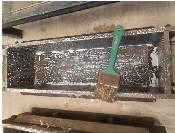
Figura 3.17: Molde prismático después de aplicado el desmoldante.
