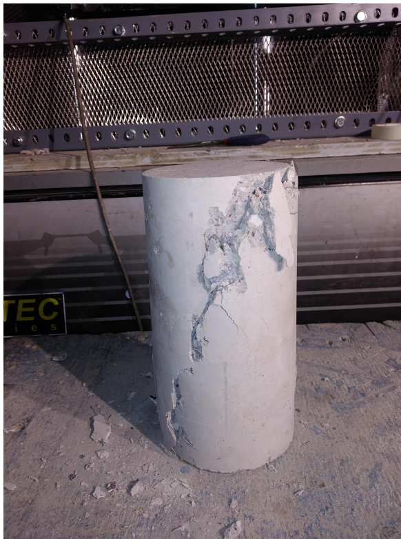
Probeta con falla típica a compresión.
