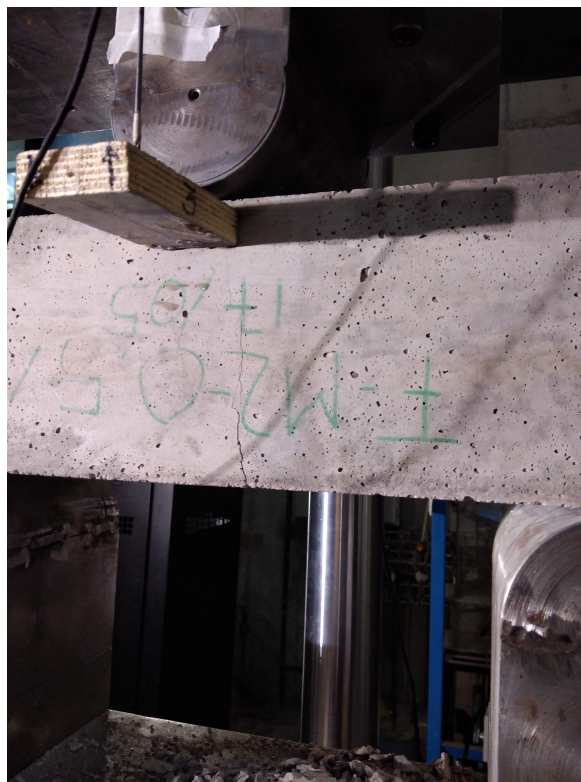
Vigueta con falla correcta en el centro de la luz en ensayo de 3 puntos.
