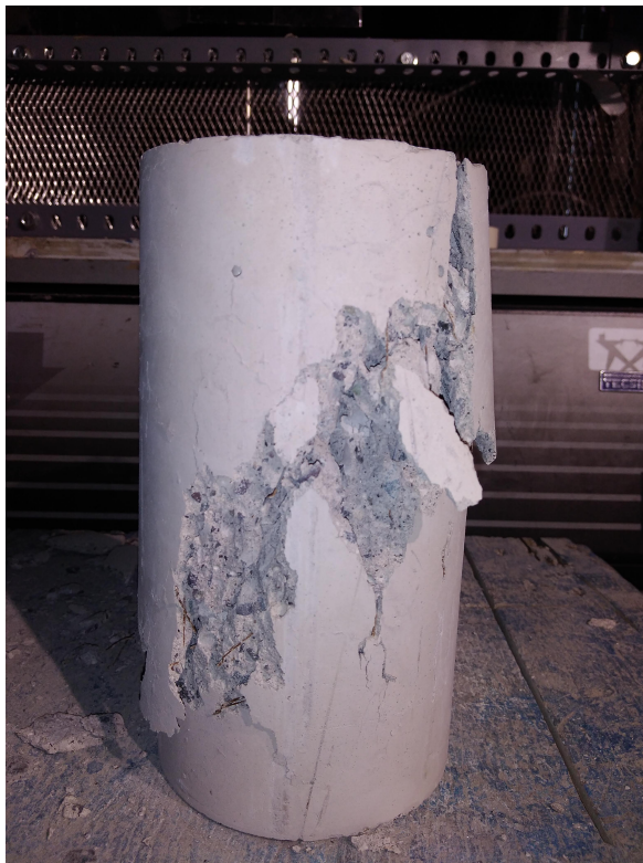
Probeta con falla típica a compresión.
