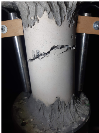
Figura 3.22: Falla correcta de la probeta.
