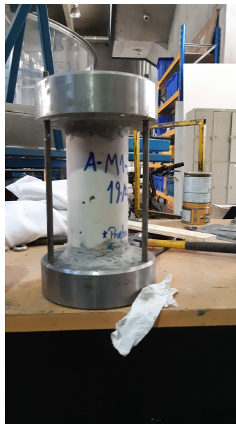
Figura 3.20: Probeta adherida a los discos de aluminio.
