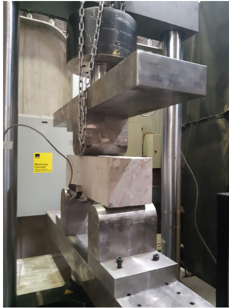
Figura 3.26: Configuración de la vigueta en ensayo de 3 puntos.
