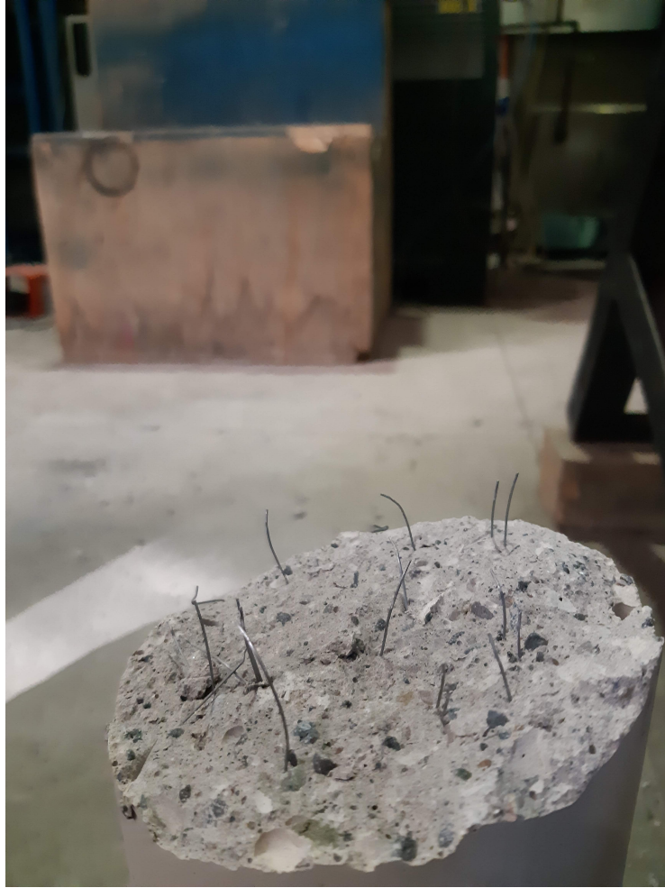
Sección transversal de una probeta ensayada a tracción.
