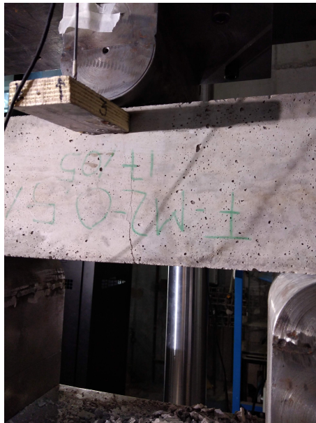
Figura 3.27: Ubicación de las bases de madera en la vigueta en ensayo de 3 puntos.
