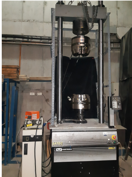
Figura 3.19: Máquina configurada en tracción.
