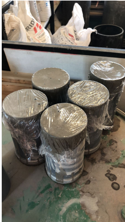
Figura 3.15: Probeta cilíndrica después de hormigonar.
