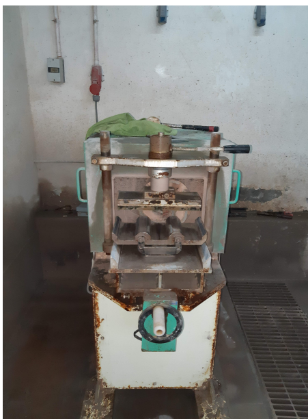
Figura 3.24: Rectificadora con la que se nivelaron las caras de la probeta.
