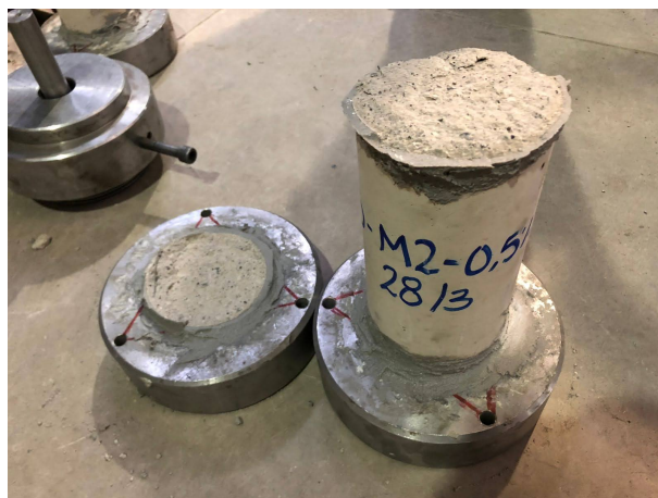
Figura 3.23: Falla incorrecta de la probeta.
