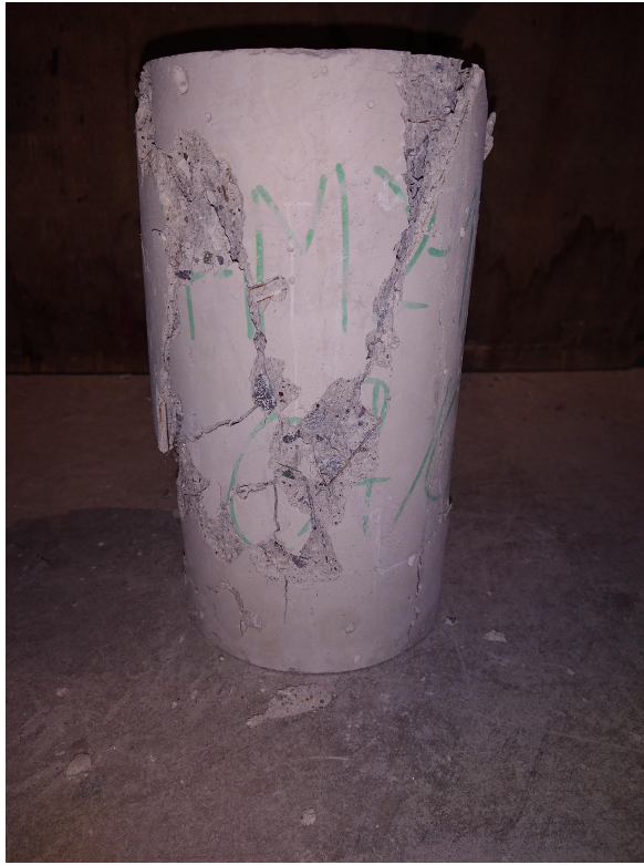
Probeta con falla típica a compresión.
