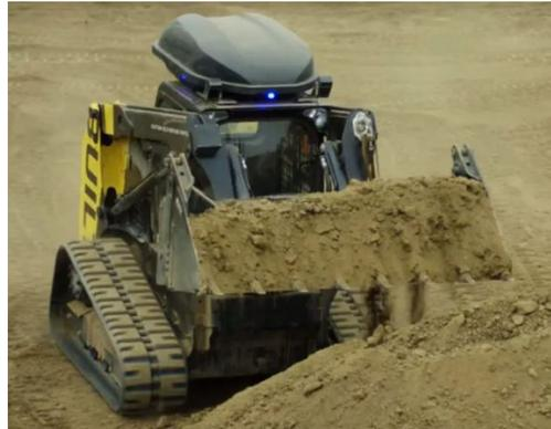
Figura 4.10: Bulldozer autónomo. [Fuente: Ovacen (s.f)]
