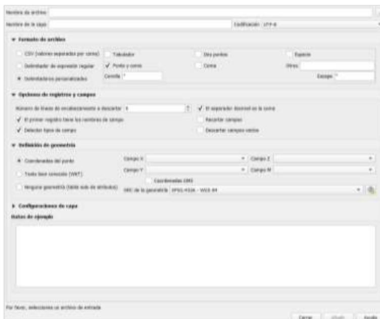
**Figura 20.** Interfaz de la herramienta [Añadir capa de texto delimitado] en la barra superior que muestra las distintas opciones para añadir una capa de información geográfica en el software QGIS.
