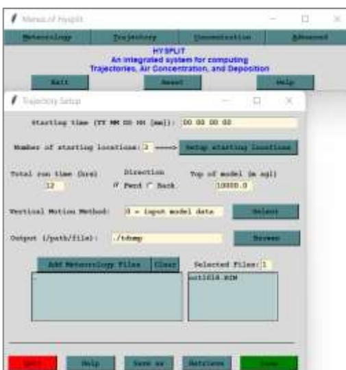
**Figura 13.** Interfaz de usuario (GUI) del software Hysplit en su versión offline en la ventana superior junto a la configuración de los parámetros para las trayectorias en la ventana inferior.
