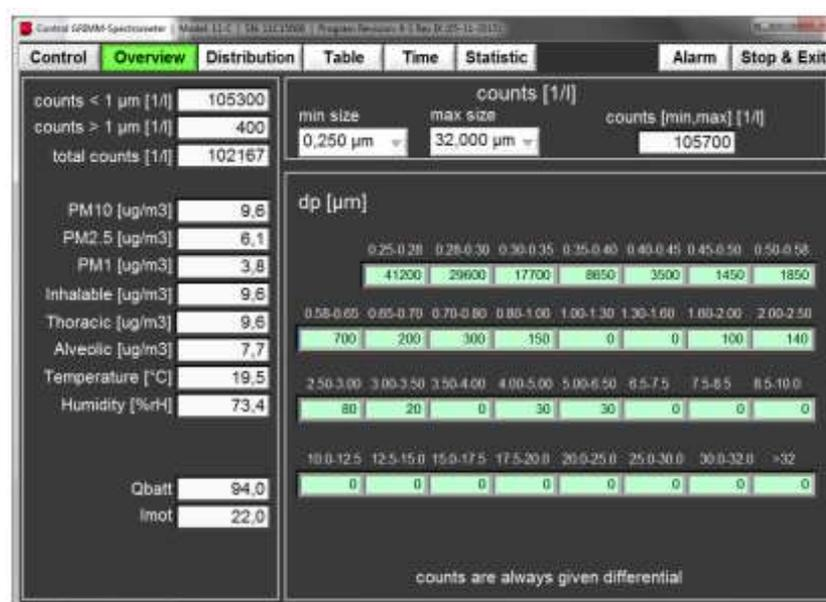
**Figura 10.** Interfaz de usuario del software *Grimm 1178*. Se presenta la vista de la visión general de los datos de material particulado, inhalable, torácica y alveólica, junto a las cuentas para cada rango de diámetros de partículas.
