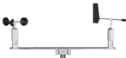
**Figura 12.** Anemómetro modelo DNA802 que integra sensor modelo DMA875 y sensor modelo DQA201 para la medición de la humedad relativa, temperatura y presión. Este anemómetro puede medir rangos desde los 0 a 50 m s<sup>-1</sup>.
