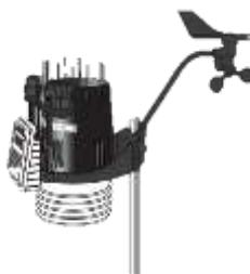
**Figura 9.** Modelo de la estación meteorológica Vantage Pro2 de *Davis Instruments*. Los sensores de temperatura y humedad están montados en un escudo de radiación junto al aspirado pasivo para minimizar el impacto de la radiación solar; la velocidad y dirección del viento es medida utilizando un anemómetro de copas y una veleta.
