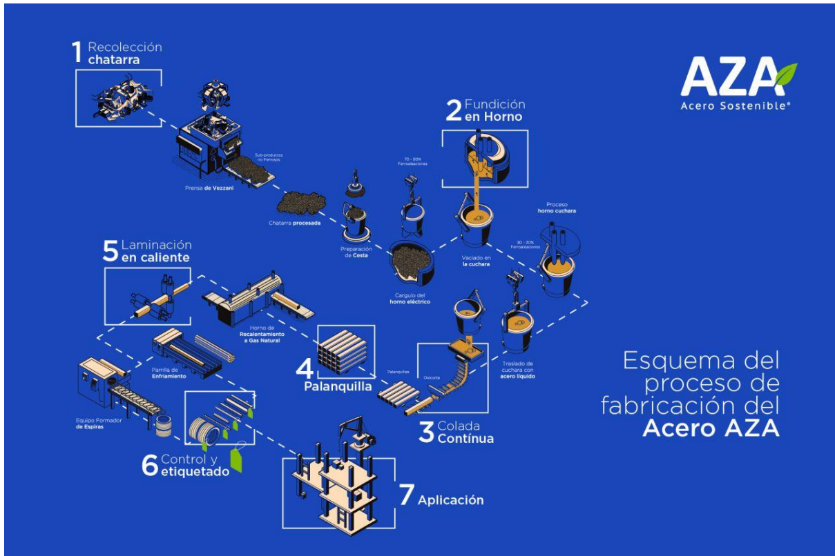
Figura 2. Esquema del proceso de fabricación del acero en AZA Nota: Fuente documento interno de AZA.
