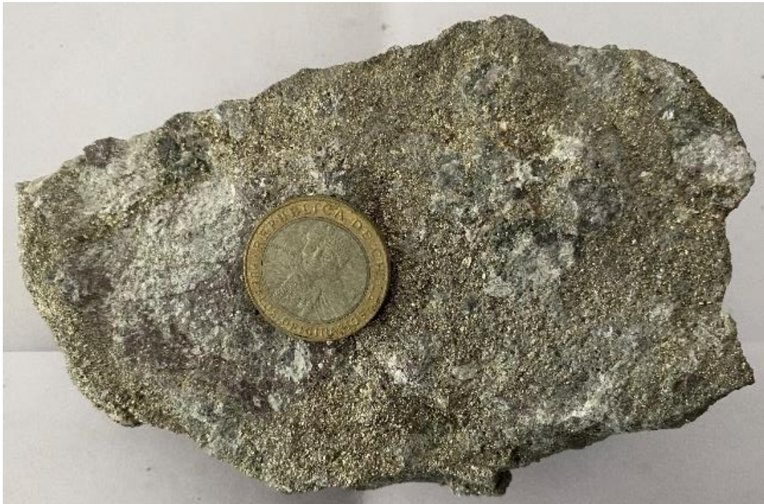
Figura 16: Muestra 537612. Roca caja con mineralización diseminada de pirita en techo de labor nivel 1055 m sector norte.
