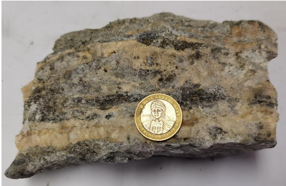
Figura 18: Muestra 539788. Veta de carbonatos-cuarzo con mineralización diseminada de pirita fina en techo de labor nivel 1055 m sector sur.
