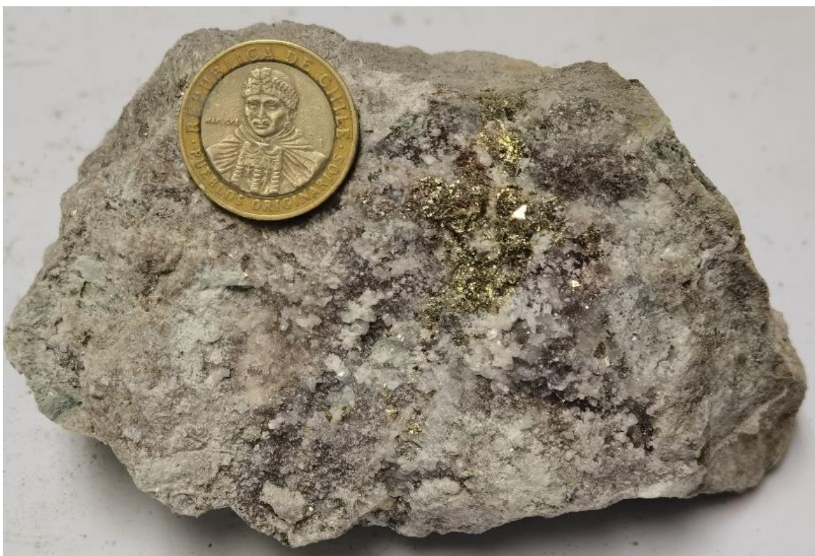
Figura 23: Muestra 537540. Roca caja con agregados de pirita en frente de labor nivel 1040 m.
