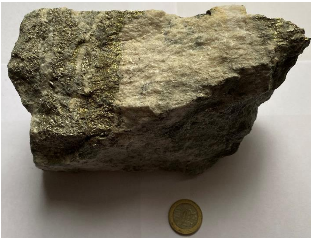
Figura 15: Muestra 537611. Veta principal de carbonatos con fragmentos de la roca caja mineralizados con mineralización de pirita y calcopirita en techo de labor nivel 1055 m sector norte.
