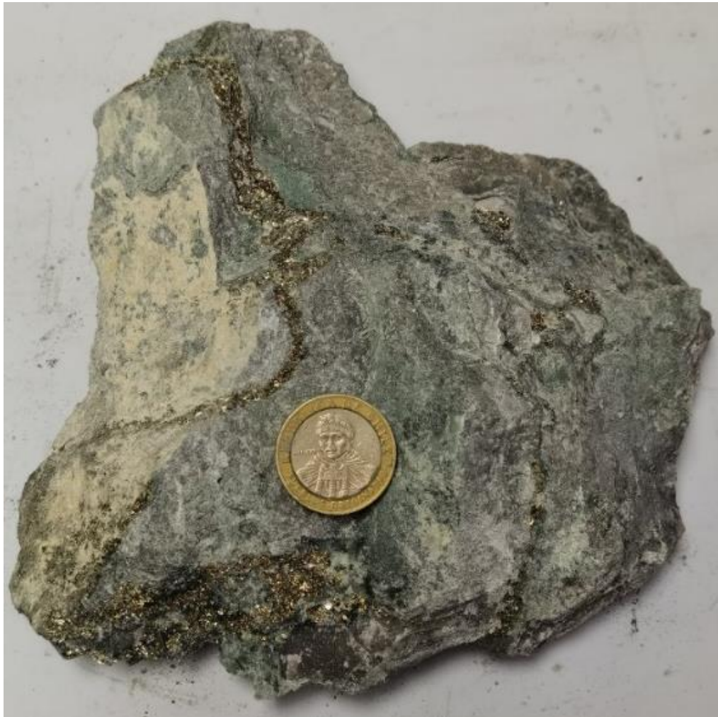
Figura 20: Muestra 539790. Roca caja con mineralización de sulfuros en vetillas y diseminados en el techo labor nivel 1055 m sector sur.
