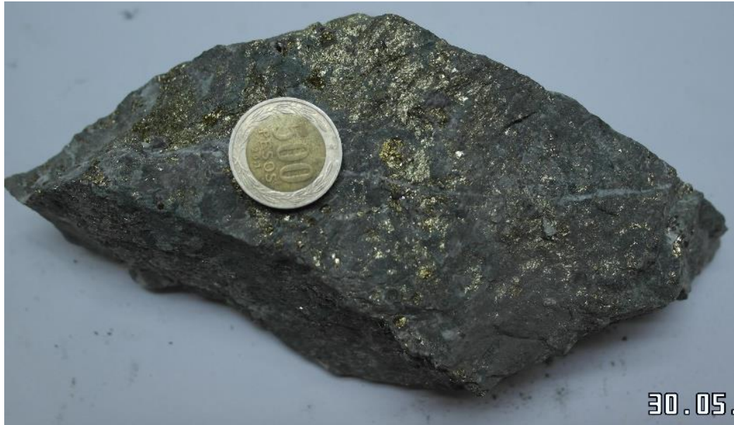
Figura 26: Muestra 537614. Mineralización en vetillas y diseminada en la frente de labor nivel 1060 m.
