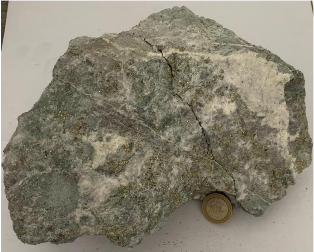
Figura 25: Muestra 537613. Zona de stockwork de carbonatos aledaña a la veta principal con una mineralización diseminada en la frente de labor nivel 1060 m.
