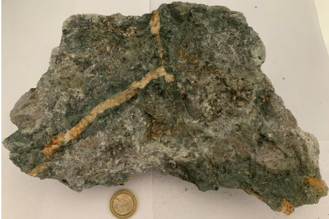
Figura 28: Muestra 539827. Roca caja cortada por vetillas de carbonatos con mineralización de sulfuros diseminados en el techo de labor nivel 1070 m.
