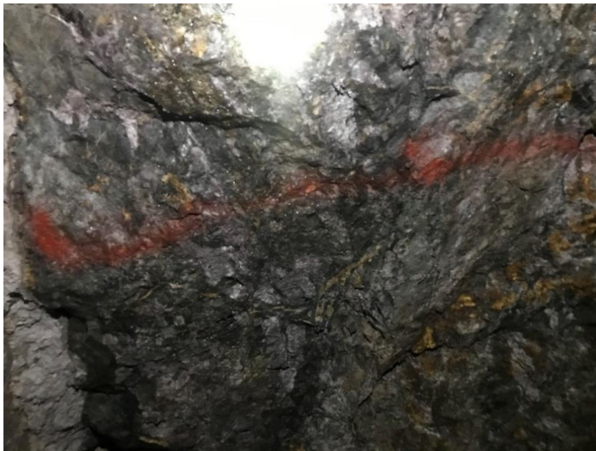
Figura 27: Fotografía de labor techo nivel 1070 m (Cl. 30). Se aprecia una roca alterada a cuarzo, arcillas y clorita con vetillas de carbonatos y sulfuros diseminados. De este sector se obtuvo la muestra 539827.
