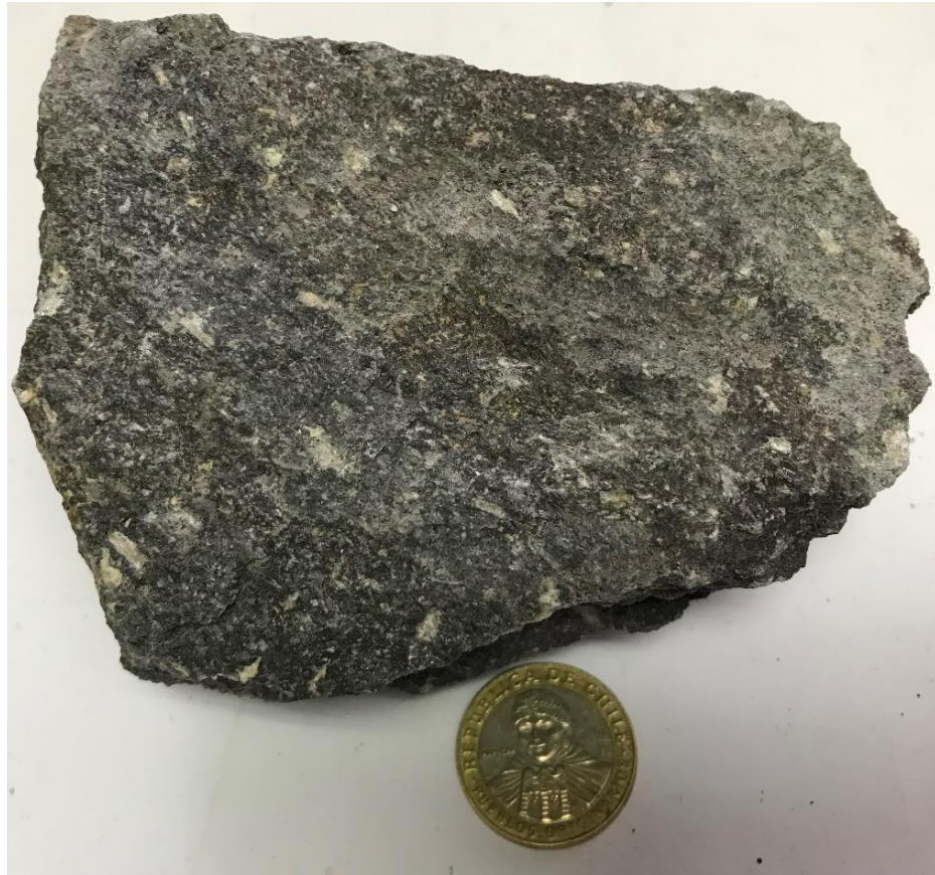
Figura 29: Muestra de lava porfírica de composición andesítica/basáltica con fenocristales de plagioclasas alterados a sericita en una masa fundamental fina argilizada y silicificada.
