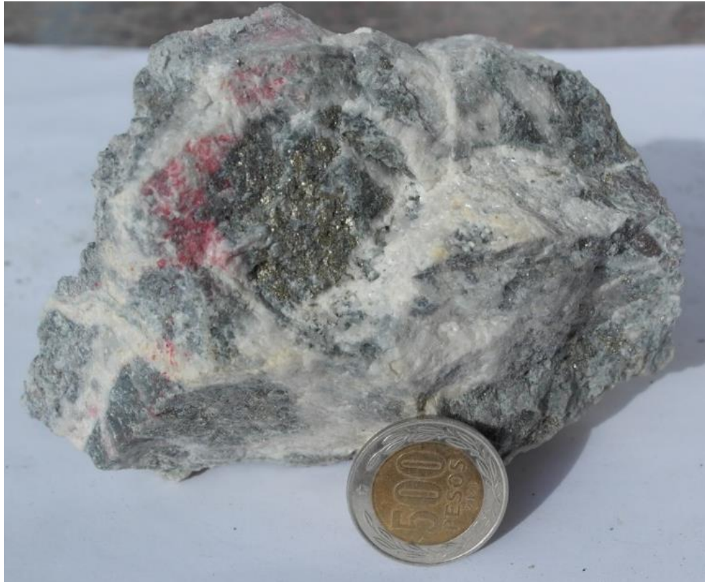
Figura 22: Muestra 537539. Brecha hidrotermal con matriz de carbonatos-cuarzo y mineralización diseminada en los fragmentos de andesita en frente de labor nivel 1040 m.
