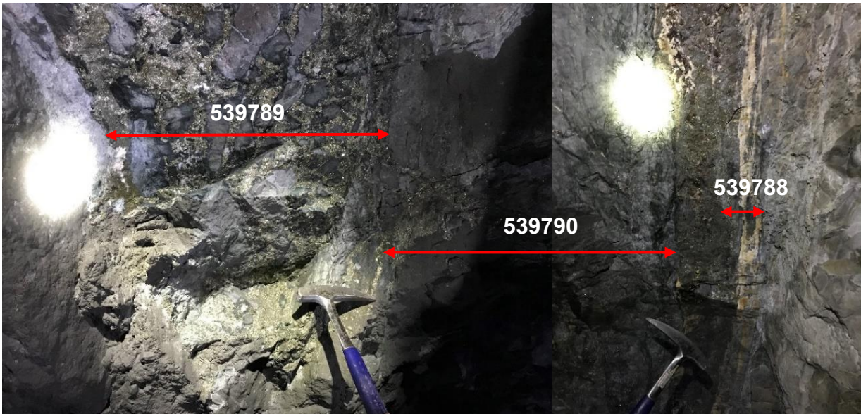
Figura 17: Fotografía de labor techo nivel 1055 m sector sur. Se aprecian tres zonas: la primera se ubica hacia el sector izquierdo y corresponde a una zona de brecha hidrotermal con una matriz de sulfuros donde se obtuvo la muestra 539789. La segunda corresponde a la zona central del techo donde se observaron sulfuros diseminados y en vetillas de donde se obtuvo la muestra 539790. La tercera se ubica hacia el sector derecho y corresponde la veta con un halo de mineralización diseminada de donde se extrajo la muestra 539788.
