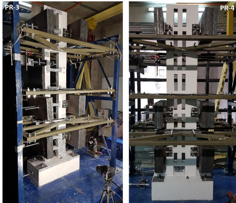
Figura 39: Sistema de carga axial PR3 y PR4
