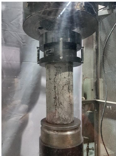
Figura 31: Ensayos de hormigón
