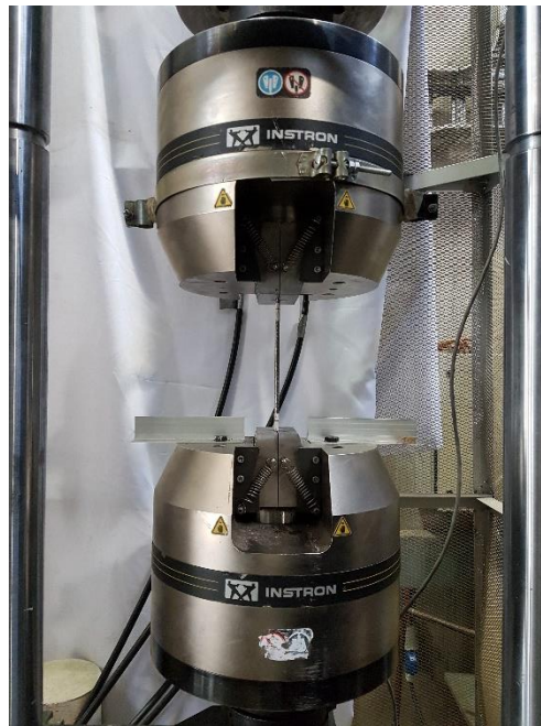
Figura 32: Ensayos de barras de acero
