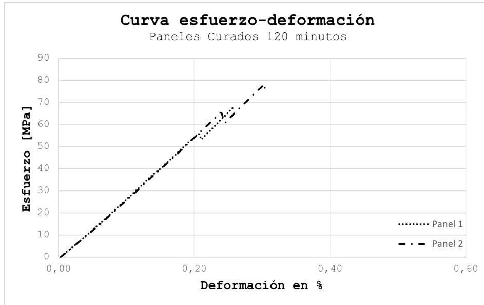
Figura 4.37: Curva de flexión para panel curado 120 minutos.
