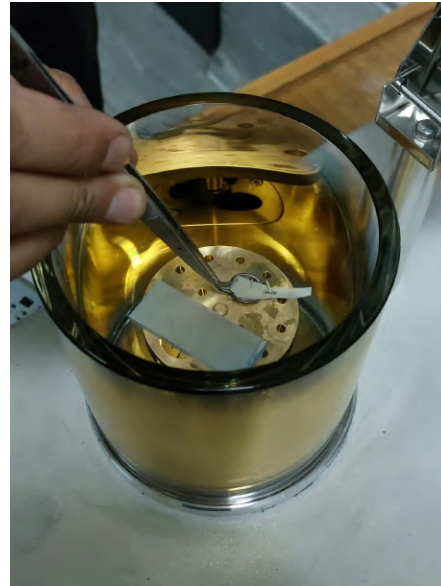
(b) Extracción de piezas con capa de oro.
