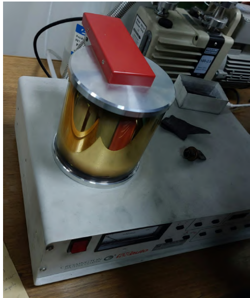
(a) Inyección de oro al vacío.
