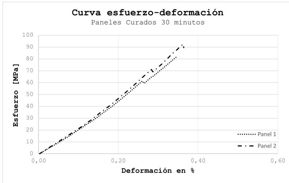
Figura 4.36: Curva de flexión para panel curado 30 minutos.
