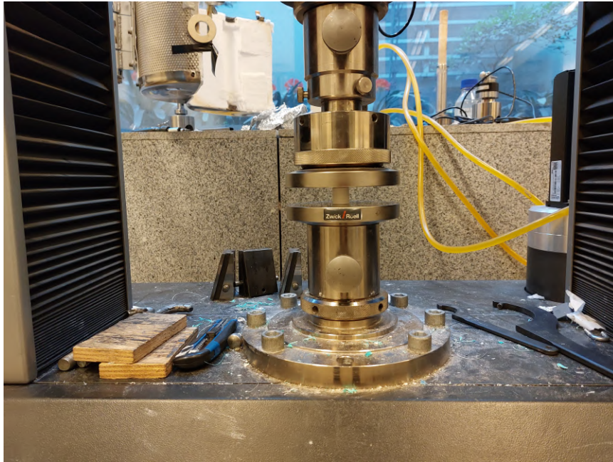
Figura 4.11: Configuración del ensayo de compresión
