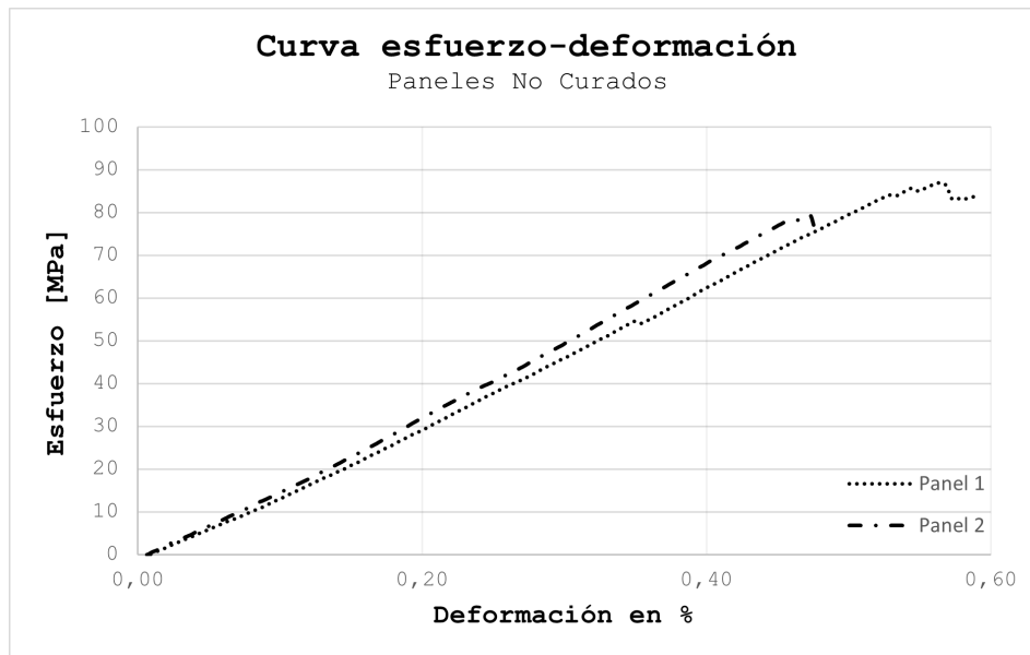
Figura 4.34: Curva de flexión para panel no curado.
