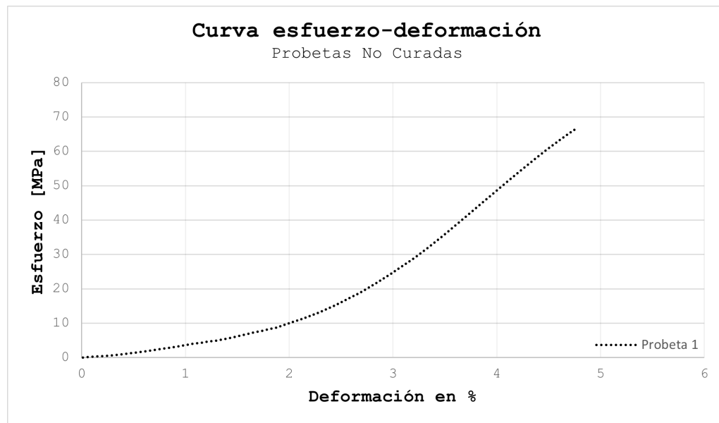
Figura 4.5: Curva de tracción para probeta no curada.
