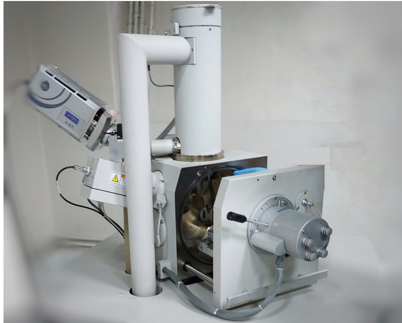
Figura 2.14: Microscopio electrónico de barrido. Geología, FCFM.
