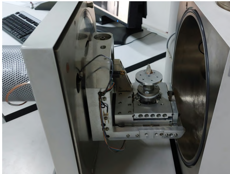
Figura 4.43: Probetas cobfiguradas en el microscopio electrónico de barrido.
