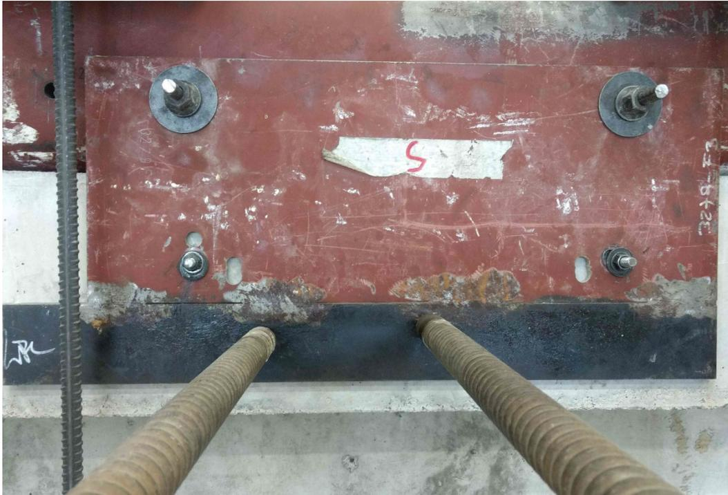
Figura 6.5: Sistema de restricción lateral
