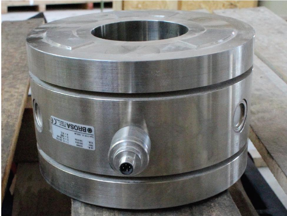
Figura 6.6: Celda de Carga
