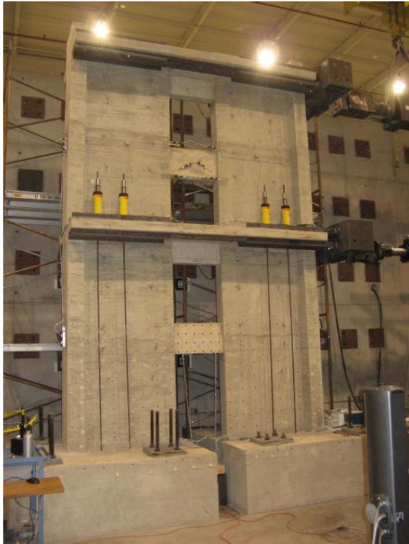
Figura 2.4: Montaje Experimental de la Investigación (Lequesne et al., 2009)
