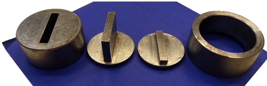
Figura 3.2: Molde metálico utilizado para fabricar las muestras cerámicas.
