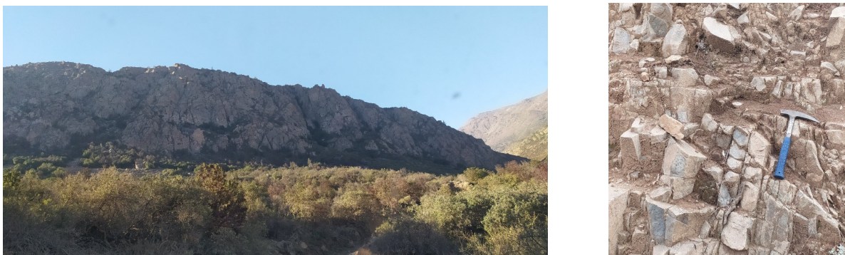
Figura 8.3: Meteorización en basamento. En la primera imagen se observa el depósito aluvial, que colinda con un cerro perteneciente a la Fm. Las Chilcas. En la segunda imagen se observa un afloramiento de basamento con fracturamiento. Imágenes pertenecientes a Quiroga (2023).
