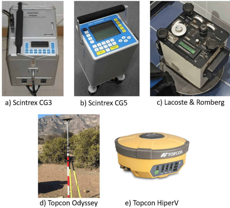
Figura 6.1: Gravímetros y GPS diferenciales utilizados en adquisición de datos.
