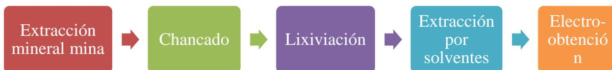
Los minerales oxidados son reducidos de tamaño generalmente mediante 3 etapas de chancado primario, secundario y terciario. Luego el producto obtenido desde estas etapas de chancado se acopian en pilas para realizar la lixiviación en que se riega el mineral con una solución de sulfúrico que percola a través de toda la pila, luego se recolectan los líquidos enriquecidos que se llevan a la planta de proceso de recuperación de la sustancia mineral.
