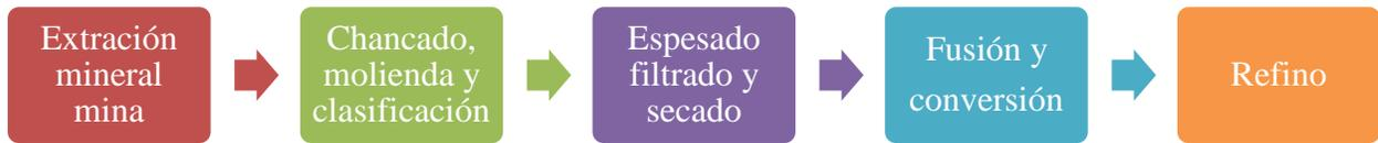
Desde la mina se obtienen los minerales sulfurados obtenidos mediante perforación, tronadura y extracción del mineral. Posteriormente se realiza el carguío y transporte de estos minerales, que tienen un tamaño aproximado entre 10-100 cm, hacia la planta de chancado donde se realiza la conminución que generalmente consta de 3 etapas de chancado para entregar un producto de 6 mm a molienda donde luego se reduce el tamaño hasta aproximadamente 180 micrones.
