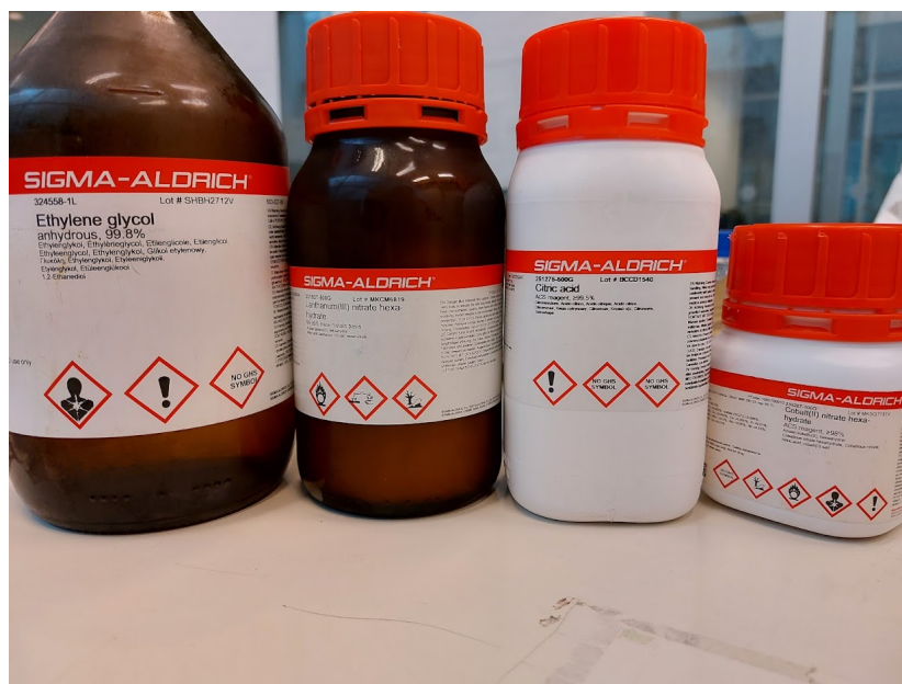
Figura 3.1: Precursores, de izquierda a derecha glicol de etileno, \text{La}(\text{NO}_3)_3 \cdot 6\text{H}_2\text{O} , \text{Co}(\text{NO}_3)_2 \cdot 6\text{H}_2\text{O} y ácido cítrico.
