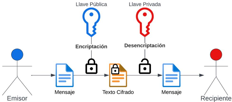
Figura 2.2: Ejemplo de un protocolo de encriptación asimétrica
