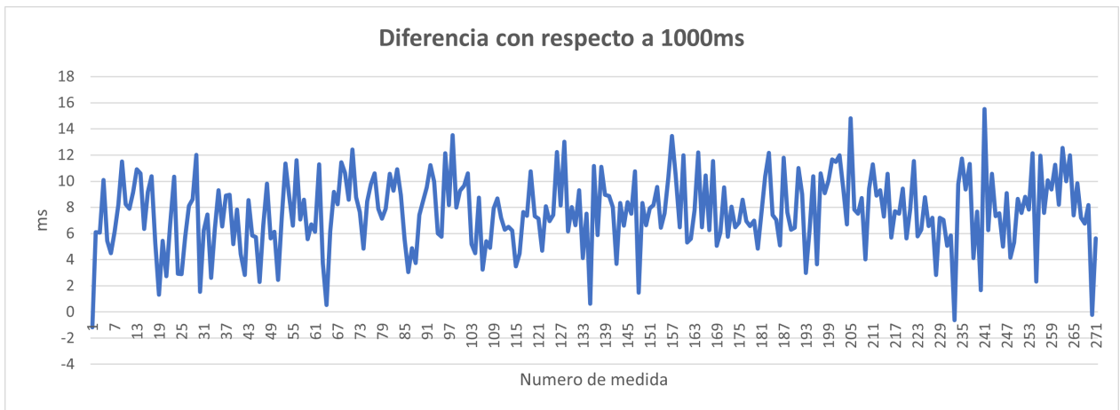
Figura 4.17: Diferencia entre intervalos de medición con respecto a 1000 [ms]
