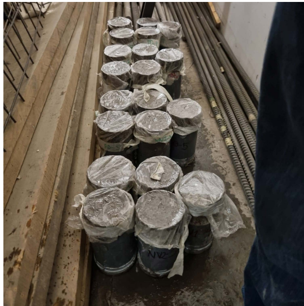
Figura 3.6: Moldes de probetas cilíndricas llenadas y selladas
