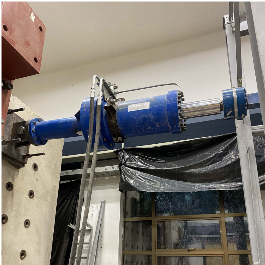
Figura 4.15: Actuador anclado al Muro de Reacción
