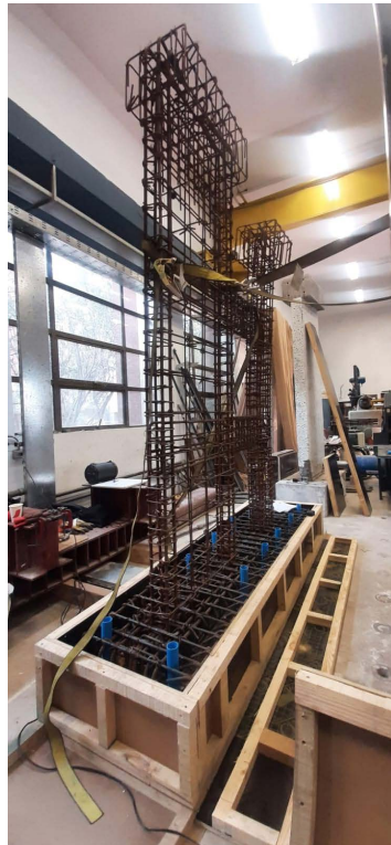
(a) Tubos de PVC en Pedestal de la Probeta
