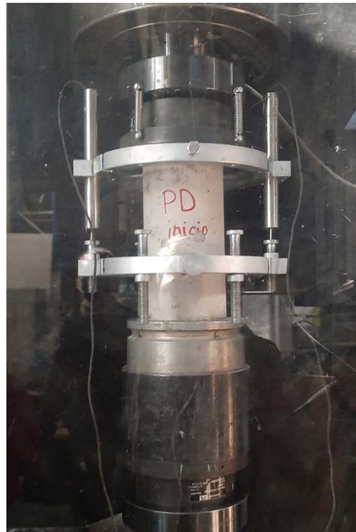
Figura 3.8: Ensayo probeta cilíndrica de hormigón a compresión
