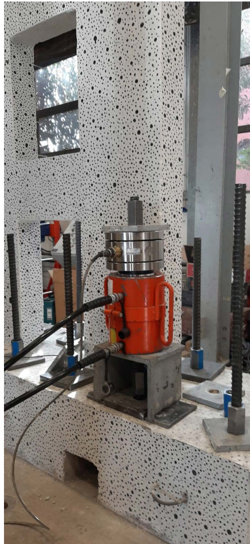
Figura 4.12: Montaje Utilizado para Postensado de Barras
