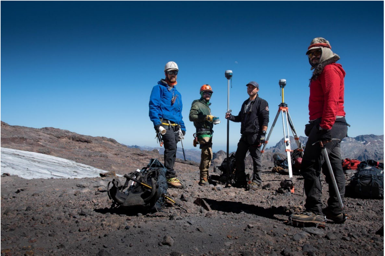
Figura 22: Receptor base (con trípode) y receptor móvil (con jalón). A la izquierda se observa parte del glaciar VPPS. Vista hacia el sur. Fotografía de David Cossio.
