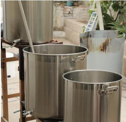
Cuenta con 2 ollas de 150 litros y recientemente compró dos ollas de 250 litros para aumentar la producción, son de acero inoxidable y se utiliza para la maceración (mezcla del grano con agua) y para hervir el mosto.
