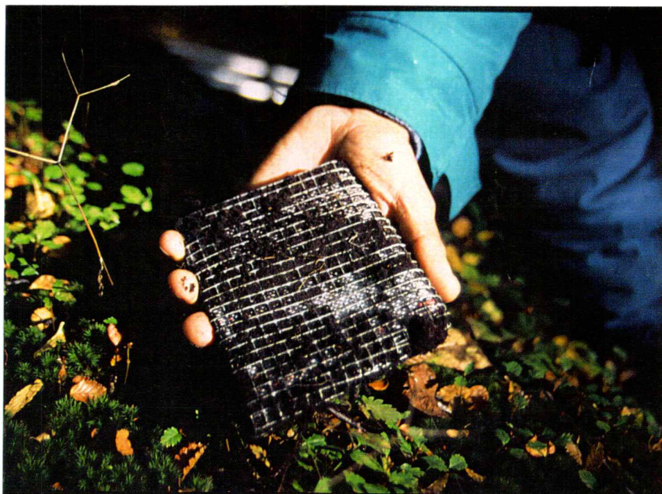
Fig. 15: Jaula de acero inoxidable envolviendo la malla plástica que contiene las nueces del experimento de entierro de frutos.
