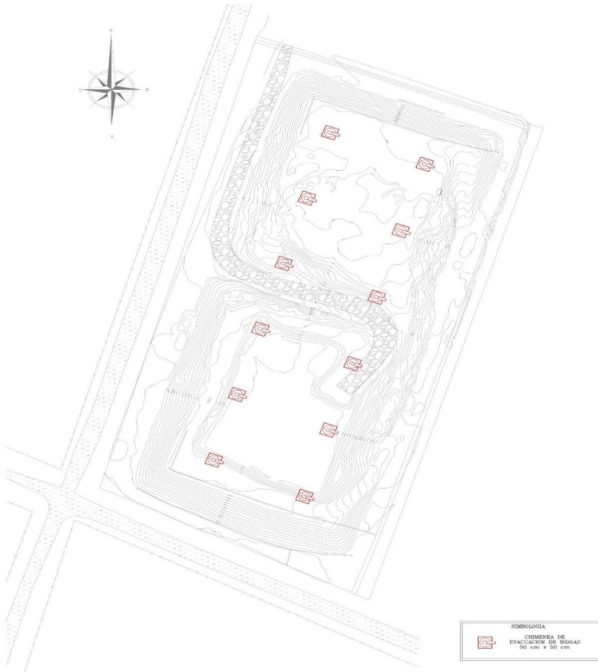
**Figura N°8-2 Distribución actual de chimeneas evacuadoras de Biogás.**
