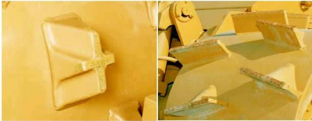
**Figura N°5-3 Diseño de diente y cuchillos autolimpiantes respectivamente.**
