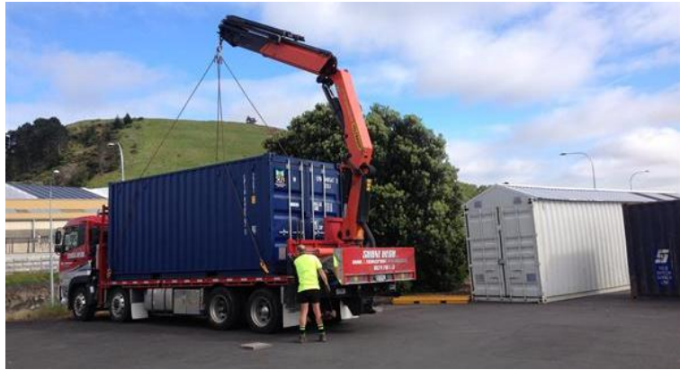
Figura 7.6: Camión con plataforma autocargable. Fuente: Google imagenes.
