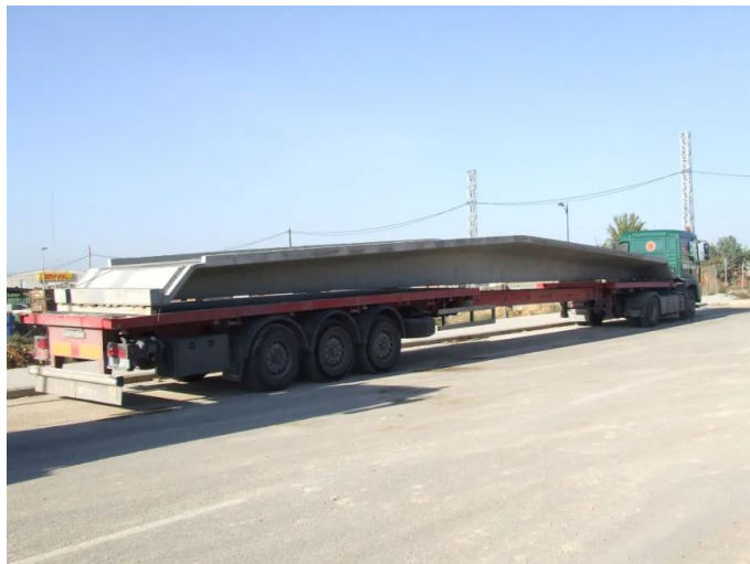
Figura 7.8: Camión con plataforma extensible. Fuente: Prefabricado seguro.
