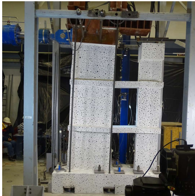
Figura 3.53: 2.0% Drift positivo - Muro deformado.
