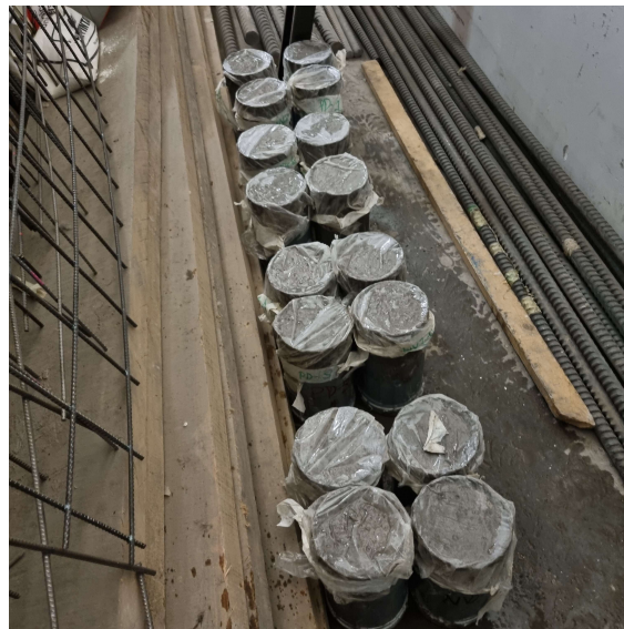
Figura 3.24: Grupos de cilindros de hormigón.
