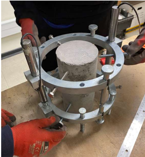
(a) Anillo para ensayo a compresión.
