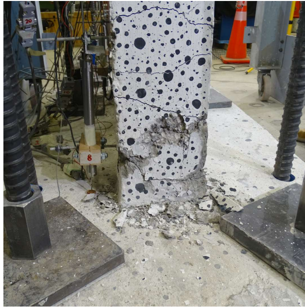
Figura 3.52: 2.0% Drift positivo - Borde con hormigón desprendido.
