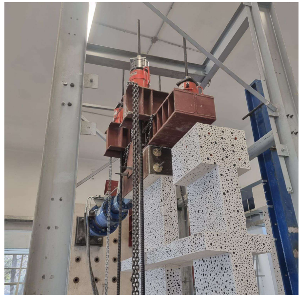
(b) Colocación del sistema de carga axial.
