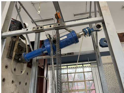
(a) Colocación actuador.
