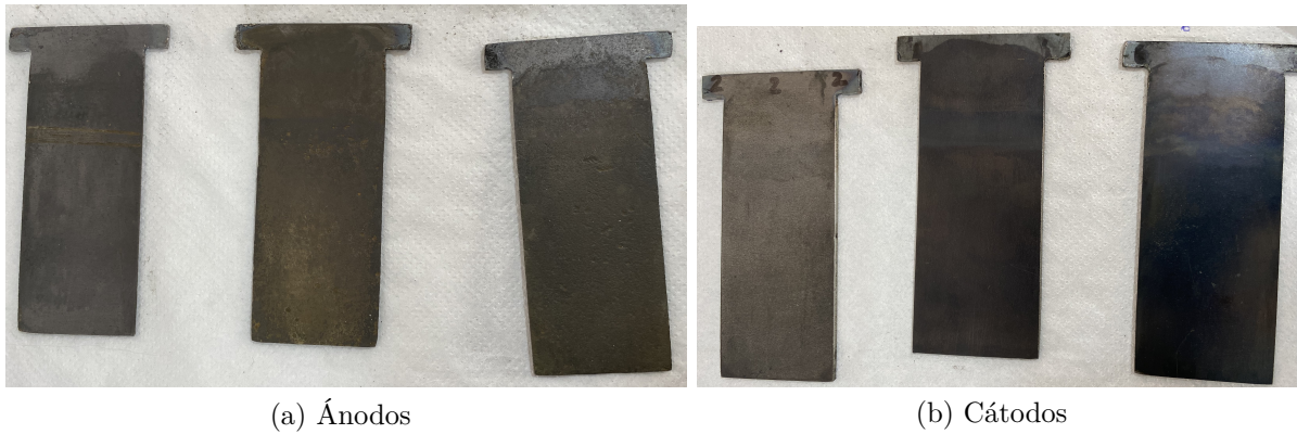
Figura A.7: Electrodos de experiencia 2 después de un batch. Después del protocolo de limpieza.
