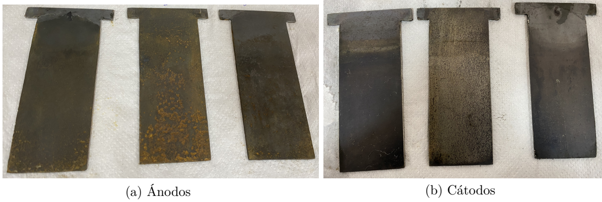
Figura A.5: Electrodo de experiencia 1 después de un batch. Después del protocolo de limpieza.
