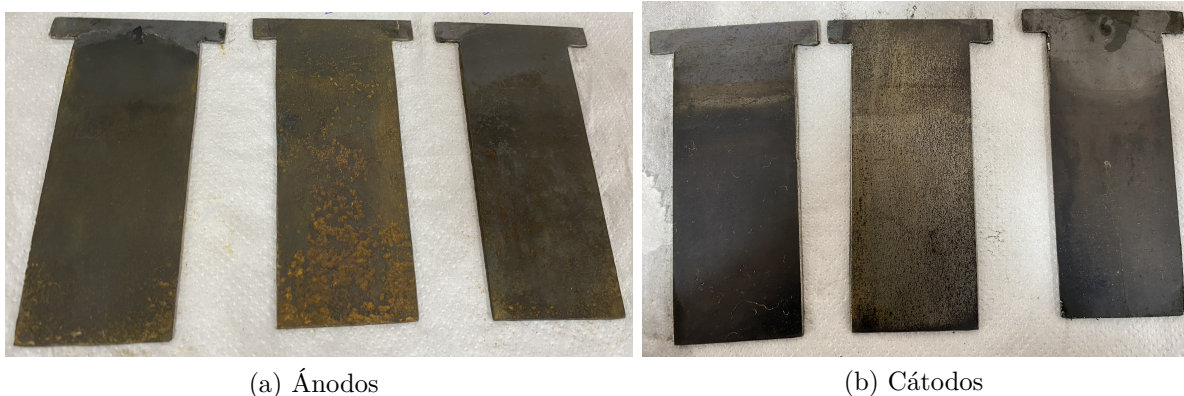
Figura 4.10: Electrodos de experiencia 1, empleados en un batch, después del protocolo de limpieza.
