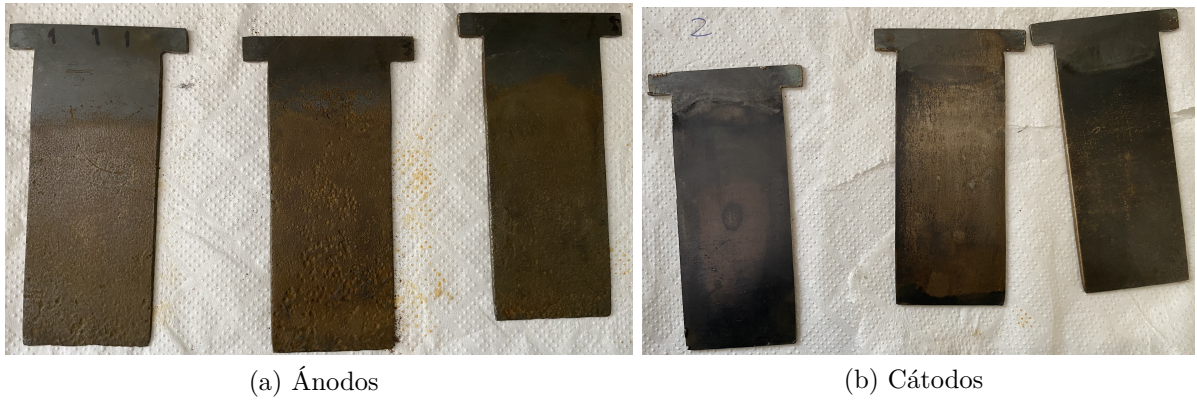
Figura 4.11: Electrodo de experiencia 1, empleados en seis batchs consecutivos, después del protocolo de limpieza.
