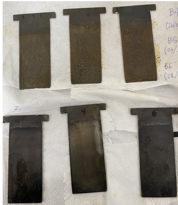
Figura A.6: Electrodo de experiencia 1 después de seis batch. Anodos arriba y cátodos abajo en la figura. Después del protocolo de limpieza.
