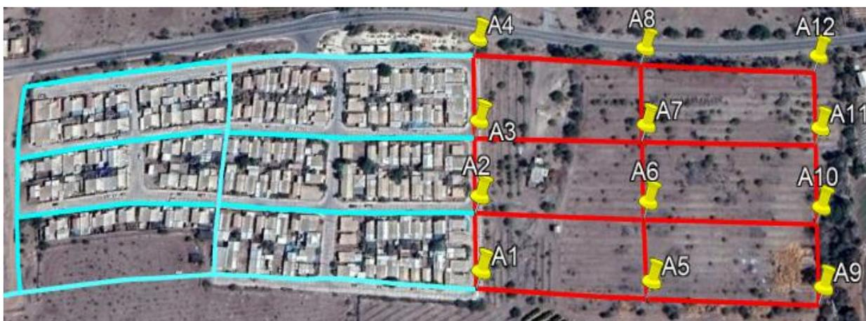
*Figura 67: Trazado de la ampliación de red de distribución en Huatulame.*
