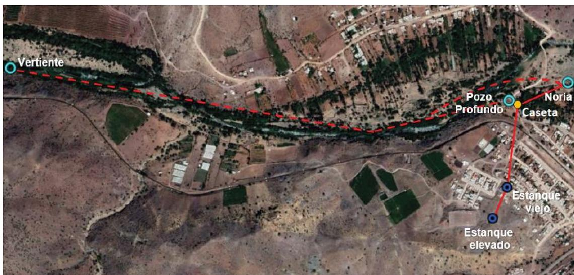
*Figura 17: Esquema de redes conducción APR San Marcos.*
