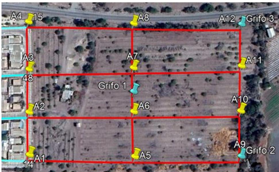
Figura 69: Plano de ubicación referencial de grifos en ampliación de red APR Huatulame.
