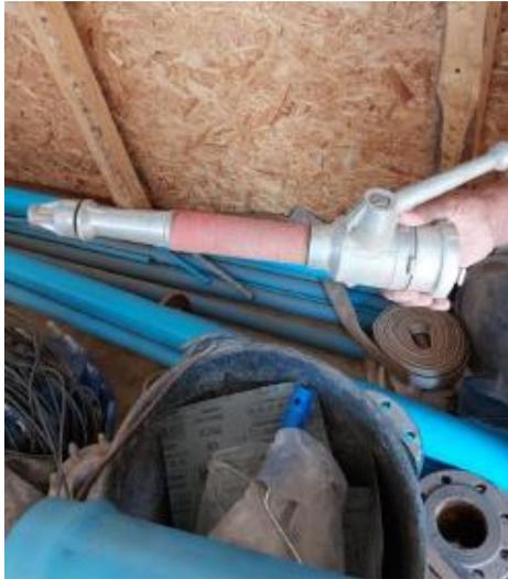
*Figura 51: Pistón de manguera a presión para hacer el lavado del estanque.*
