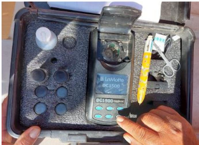
*Figura 50: Equipo analizador de niveles de cloro.*
