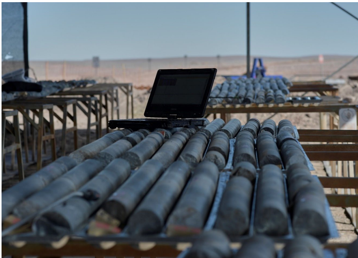
Ilustración 9: Testigos perforación diamantina. Fuente: Elaboración propia
