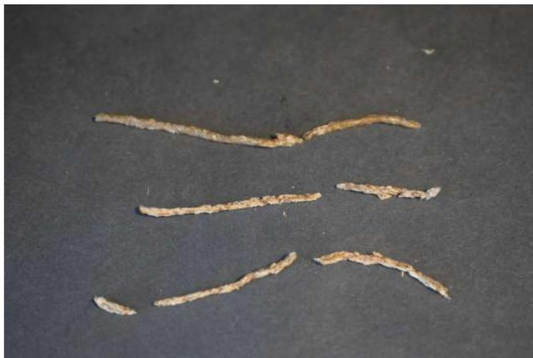
Figura 6.7: Muestra de las tintas preparadas con alginato al 14 % p/p y aserrín en proporciones 50:50, 60:40 y 70:30 (desde arriba hacia abajo) una hora después de la extrusión. Elaboración propia.
