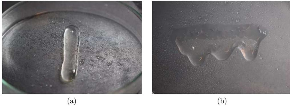
Figura 6.3: Imágenes de pruebas de extrusión manual para soluciones de alginato al 4%p/p. (a) Muestra entrecruzada y en reposo. (b) Muestra entrecruzada con inclinación. Elaboración propia.
