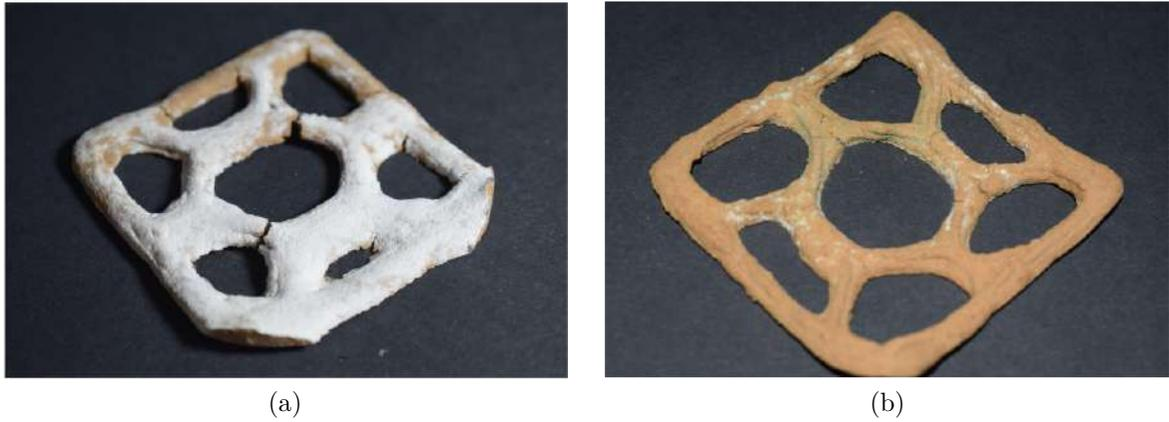
Figura 6.10: Muestra de los prototipos impresos con tintas en base a coronta de maíz y alginato al 14 % p/p, después de 3 semanas de incubación. Se observa el micelio en blanco. (a) Tinta con proporción 60:40 (sustrato:alginato). (b) Tinta con proporción 70:30 (sustrato:alginato). Elaboración propia.
