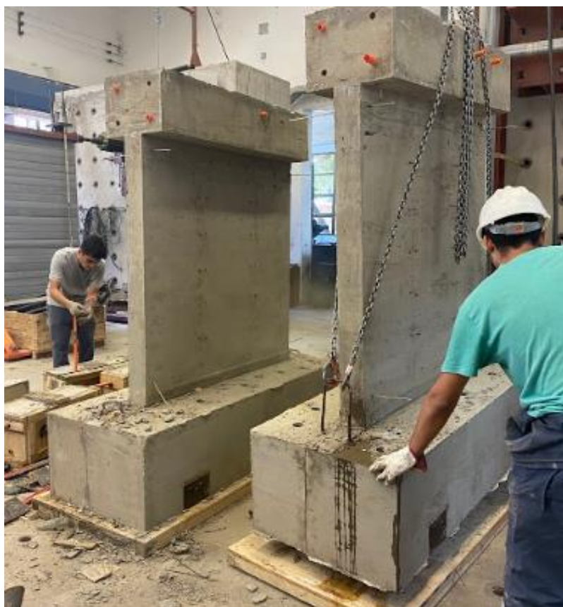
Figura 2.27: Desmoldaje de Muros Endurecidos
