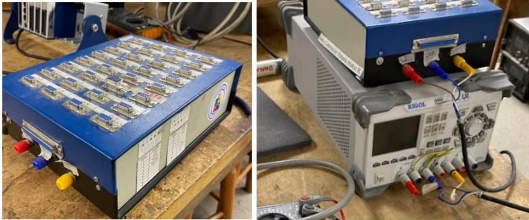
Figura 3.20: Caja de Conexión (izq) y Fuente de Alimentación (der)
