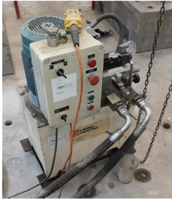
Figura 3.7: Bomba Hidráulica y Botonera Actuador
