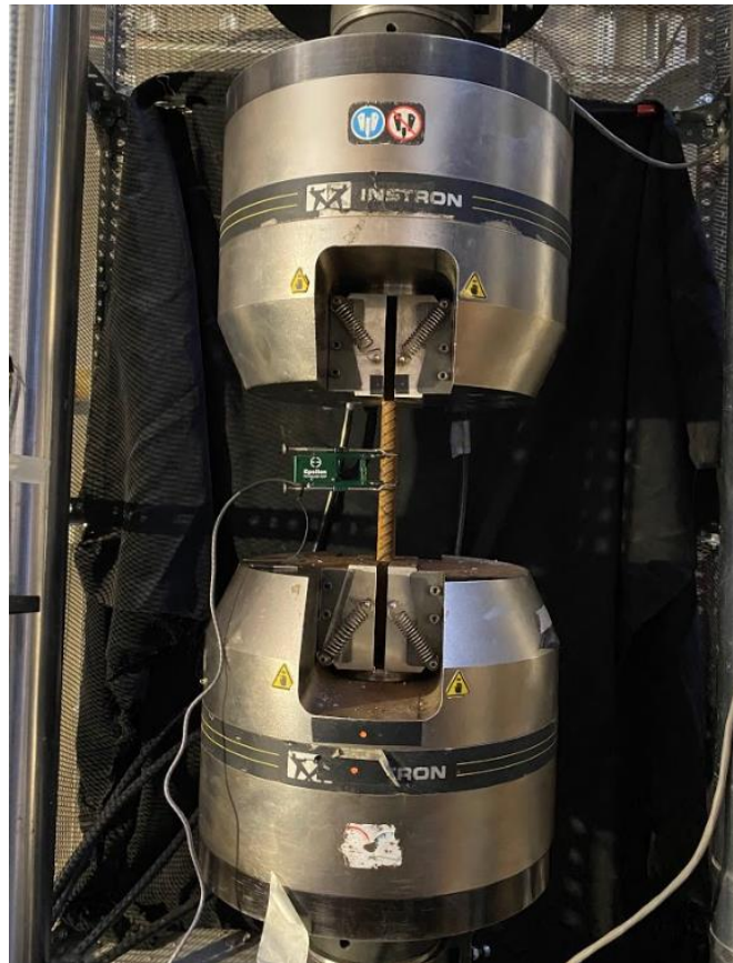
Figura 2.6: Montaje máquina universal ensayo de tracción de barras de acero
