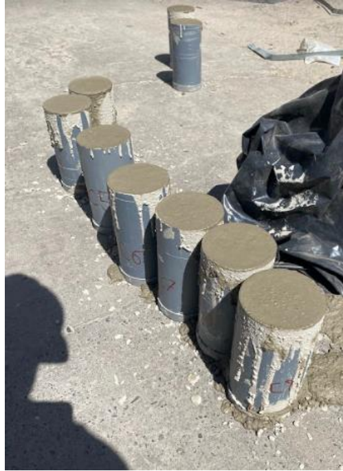
Figura 2.28: Llenado de cilindros de hormigón
