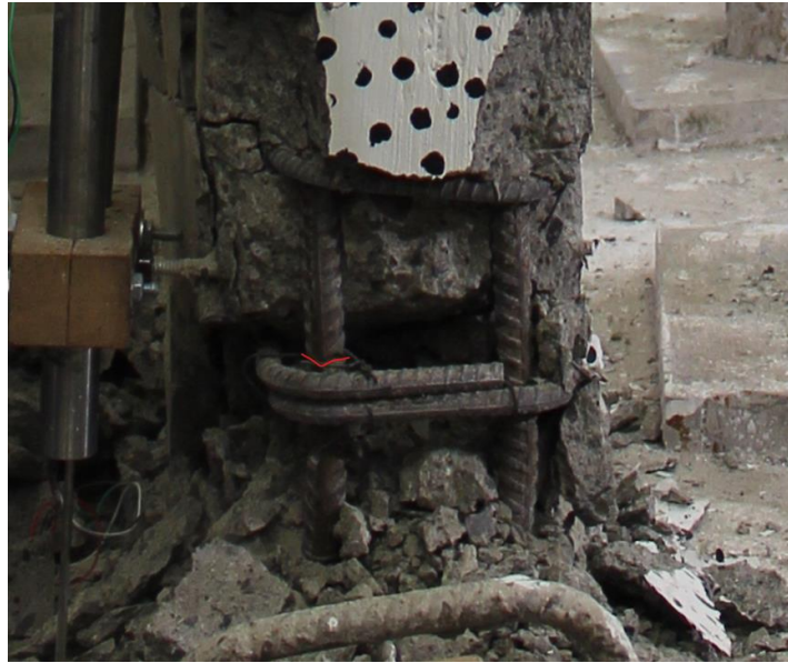
Figura 4.30: Corte de Barra Longitudinal segundo ciclo deriva 2,5%
