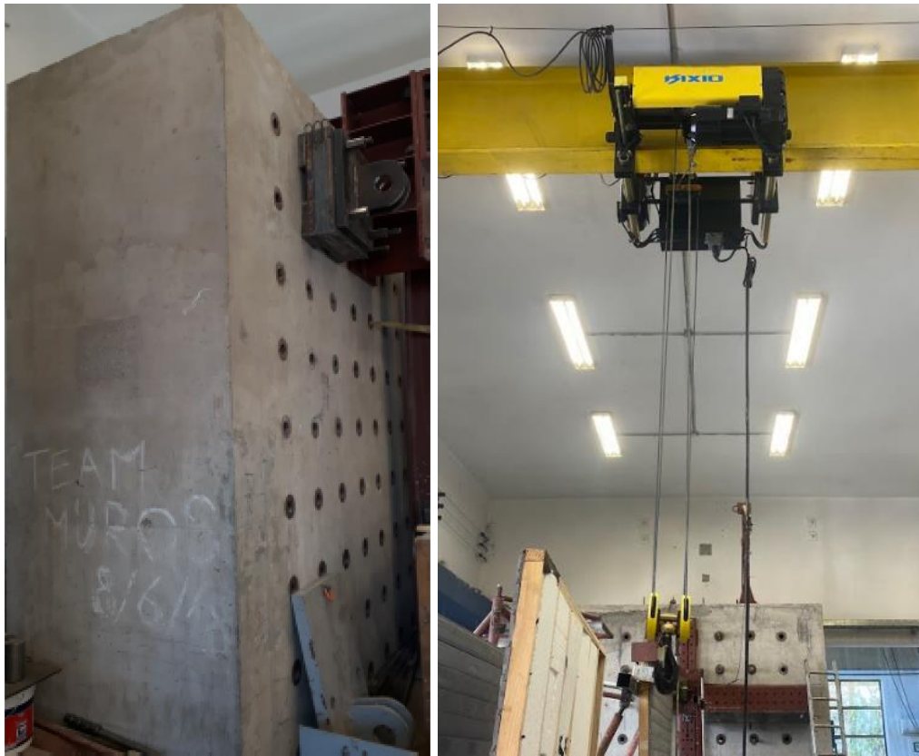
Figura 3.2: Muro de Reacción y Puente Grúa
