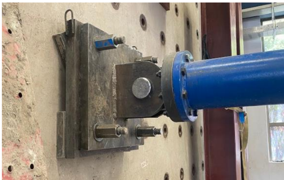
Figura 3.13: Anclaje Actuador a Muro de Reacción
