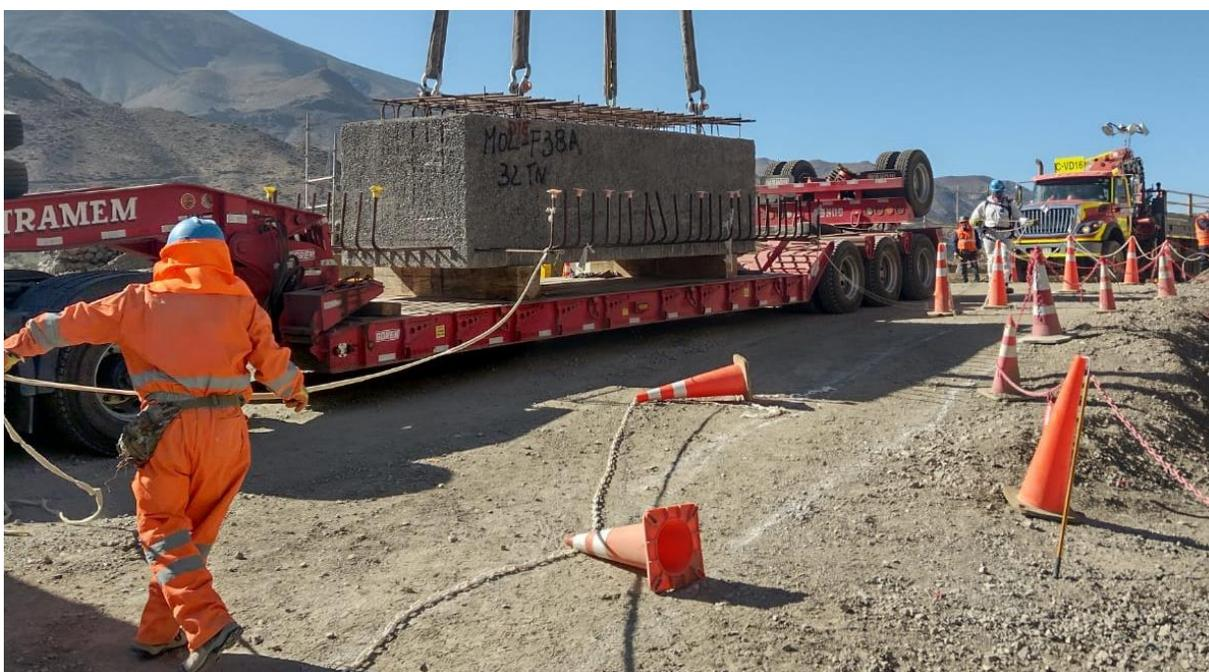
Figura 31: Cama baja cargada con elemento prefabricado (tomada por alumno).
