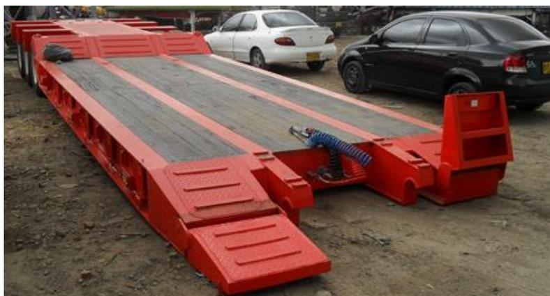
Figura 30: Funcionamiento de cuello desmontable en cama baja.
