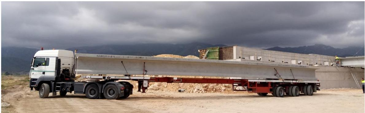
Figura 34: Transporte de viga prefabricada sobredimensionada.
