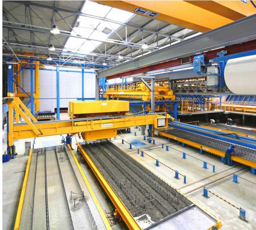
Figura 24: Ejemplo de hormigonado directo en planta prefabricadora.
