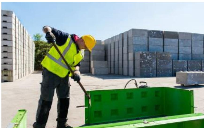
Figura 15: Limpieza de moldajes.
