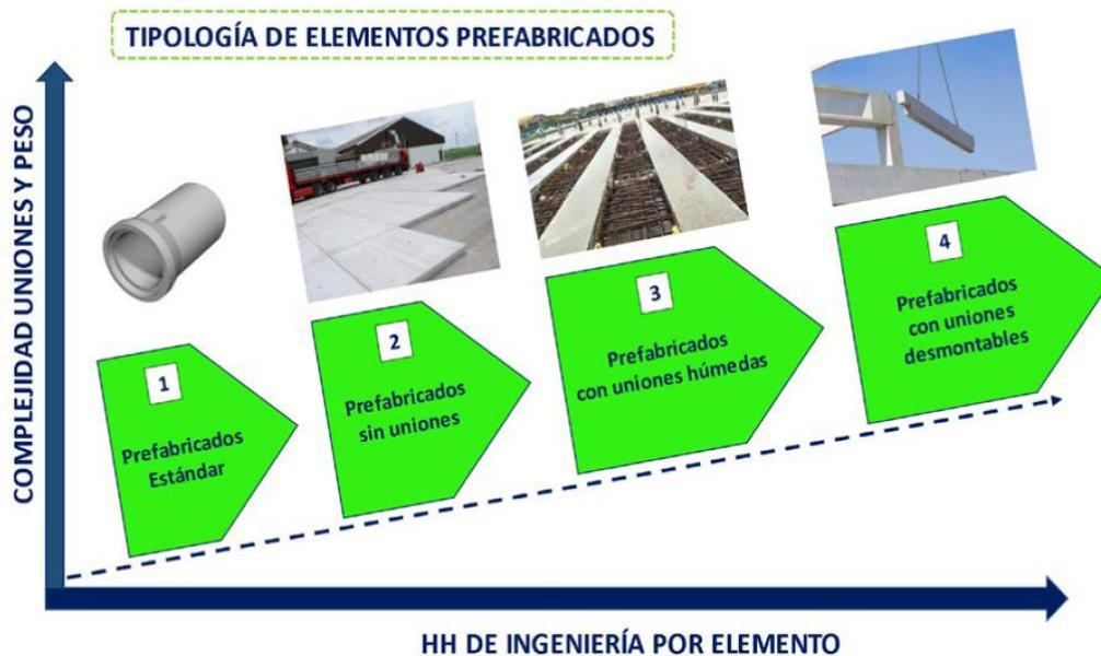
Figura 2: Diagrama de horas requeridas según tipo de elemento. (Codelco)
