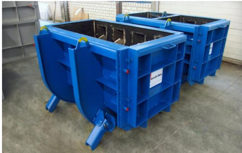
Figura 12: Moldajes con puntos de izaje.
