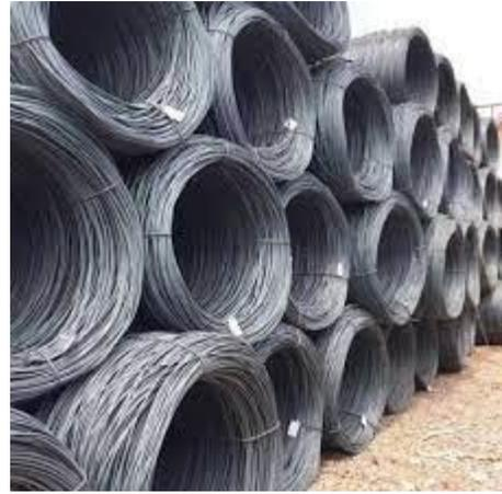
Figura 17: Paquetes de barras y rollos de acero.
