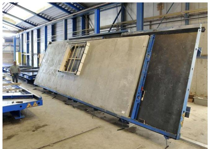
Figura 10: Mesa hidráulica basculante.
