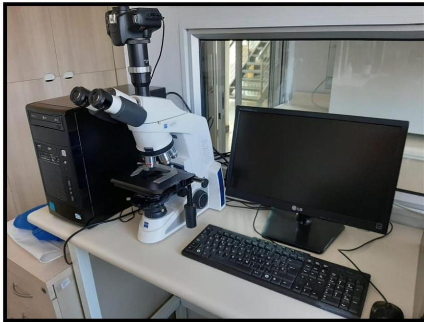
**Figura 9.** Cámara digital Canon® EOS Rebel-T3, montada en microscopio óptico Zeiss® Axio Lab. A1 y computador para obtención y procesamiento de imágenes.
