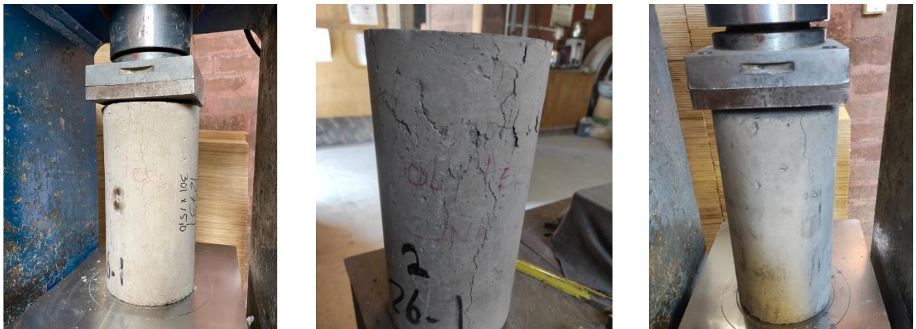
Ilustración 27: Roturas en probetas realizadas
