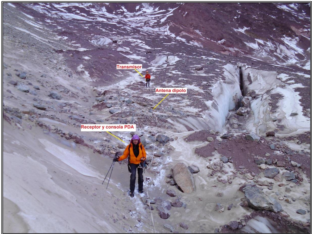
Figura 151. Levantamiento con radar para hielo en el glaciar Aparejo, Región Metropolitana. En rojo, y con fondo blanco, se indican los elementos básicos para la operación del radar; antena dipolo, transmisor y receptor. El receptor GPS se ubica hacia el frente de la imagen, transportado por el autor. Extraído de Ugalde (2016)
