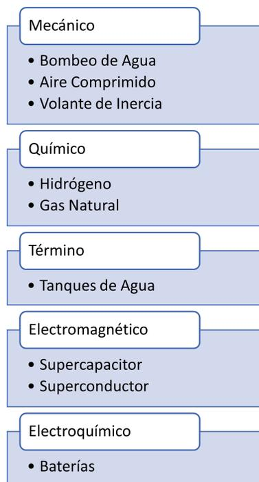
Figura 2.4: Clasificación de los Sistemas de Almacenamiento Según Tecnología.
