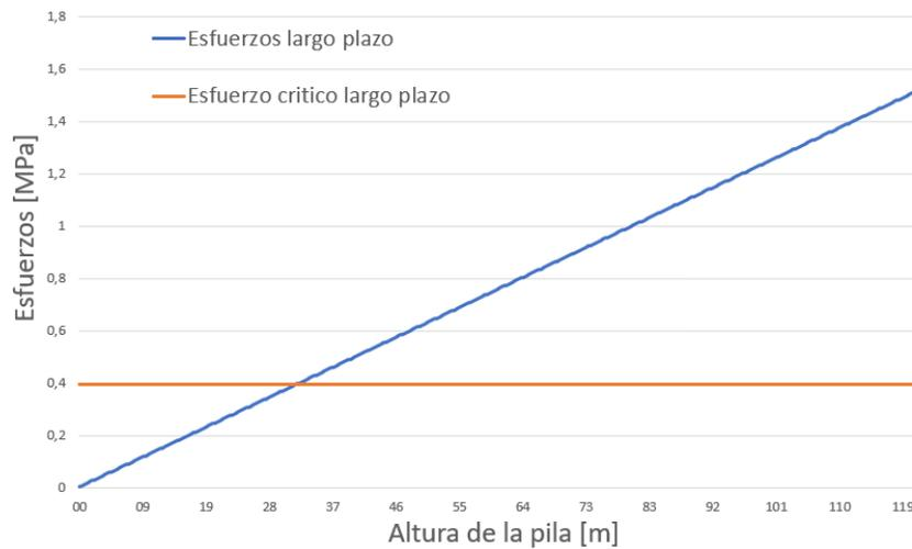
Figura 4.3: Esfuerzo a largo plazo y esfuerzo crítico a largo plazo tubería de 3[in]
