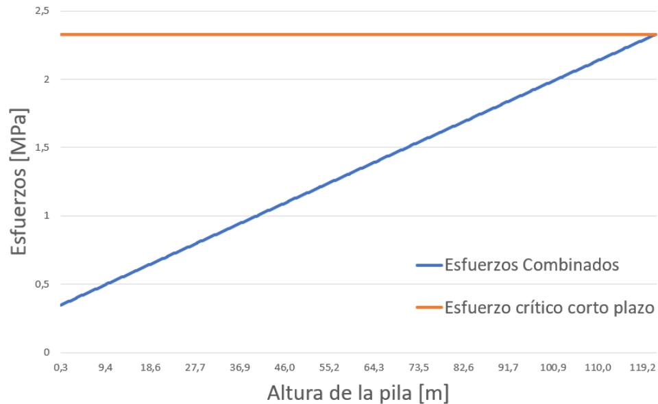
Figura 4.24: Esfuerzos combinados y crítico en corto plazo tubería de 4[in] para deformaciones mayores a 10 %
