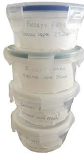
Figura 7. Almacenamiento de las probetas en solución acuosa grado II previo a su testeo.
