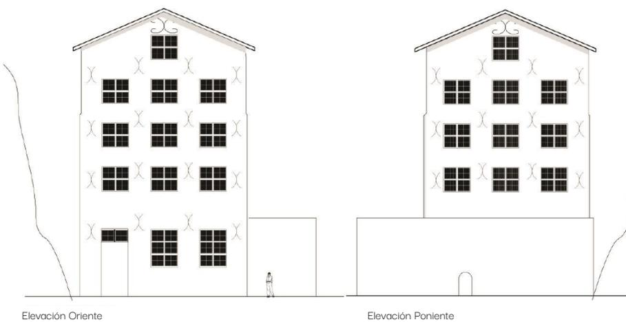
La torre en su perímetro está reforzada en cada nivel mediante anclajes de fierro fundido visibles en el exterior con forma de X uniendo el perímetro con la torre interior.
