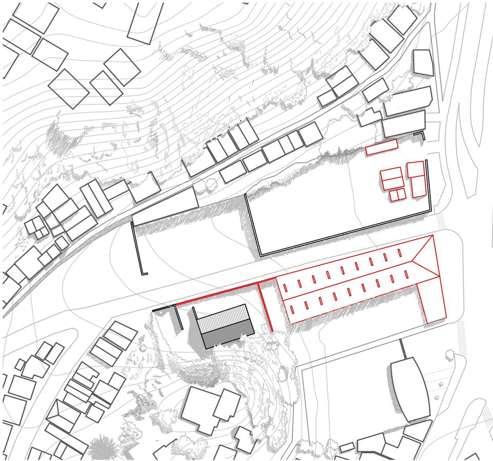
Con el fin de liberar se plantea la demolición de las construcciones en rojo para proponer nuevos espacios que busquen una integración del conjunto con el terminal y el espacio público.
