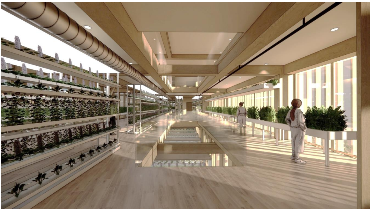
Render 10: Zona de cultivos hidropónicos. Sistema Nutrient Film Technic a la izquierda y Sistema de sustratos a la derecha.
