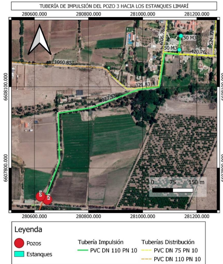
Figura 3-9. Impulsión desde pozo N°3 a los Estanques
