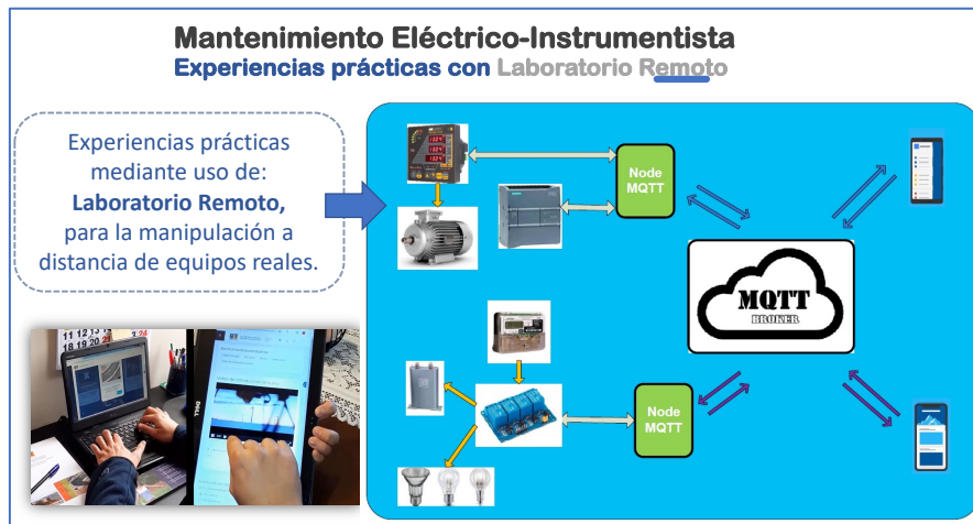
Figura N°2: Lógica de operación de laboratorios remotos para actividades eléctrico instrumentistas. Elaboración propia
