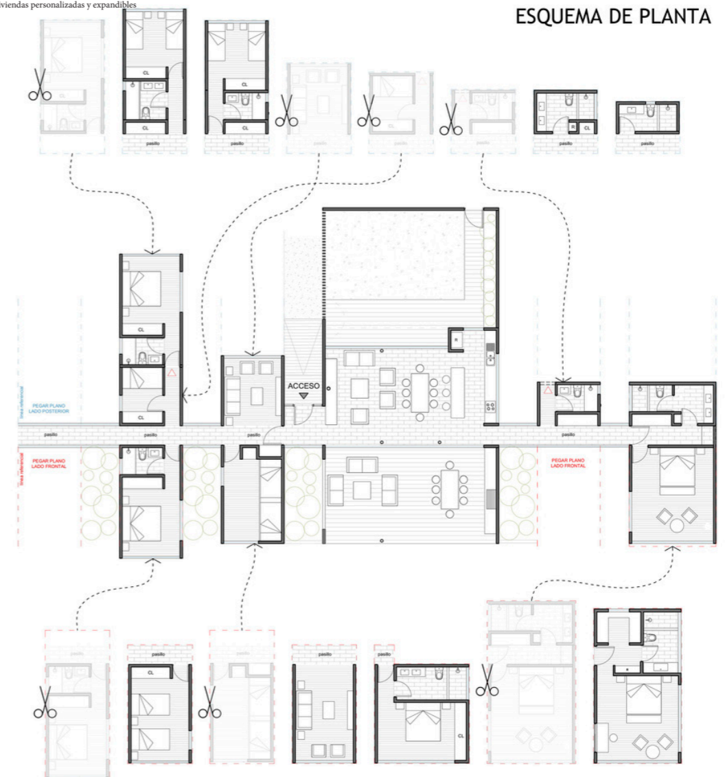
Casa Aditiva Fuente: Archdaily Casa Aditiva : Un sistema modular y estandarizado que permite construir viviendas personalizadas y expansibles
