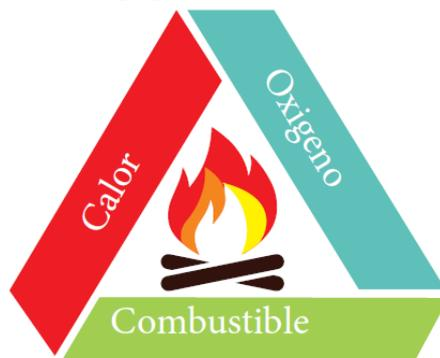
Figura 2. Triángulo del Fuego.
