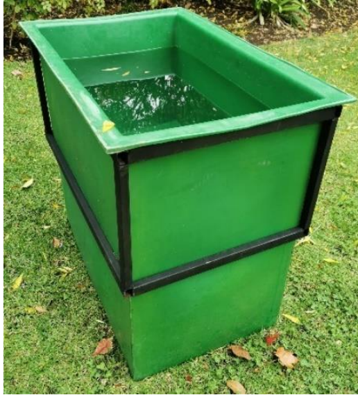
Apéndice I. Prueba de llenado de uno de los estanques para el tratamiento biológico de agua.
