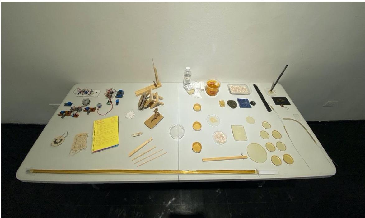
Mesón de procesos. En la imagen se observan las pruebas de materiales en placas electrónicas, placas tejidas, maquetas de mecanismos, moldes y pruebas de biomateriales con diferentes bases, un cuaderno de apuntes.
