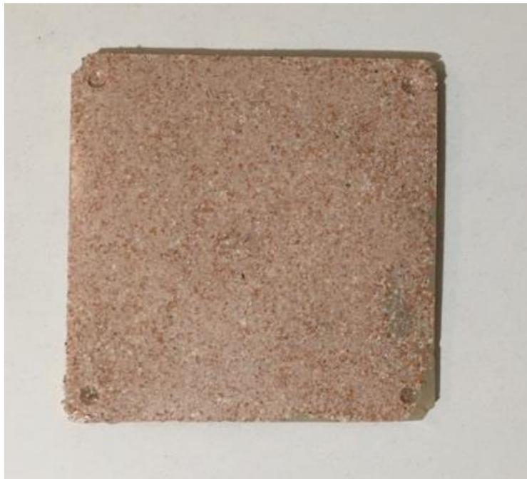
Fig. 40. Día 5 de cocinado. Al desmontarlo del molde no presenta contaminación visible, aunque si se aprecia desprendimiento de la cáscara en algunos sectores
