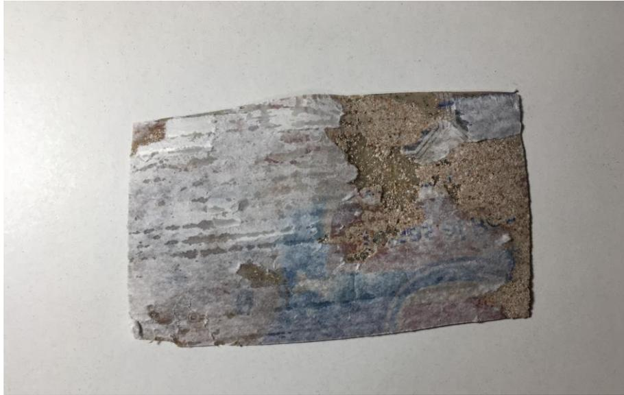
Fig. 39. Día 5 de cocinado. El biomaterial al desmontarse se pega en la superficie del molde y rompe, por lo que se recicla
