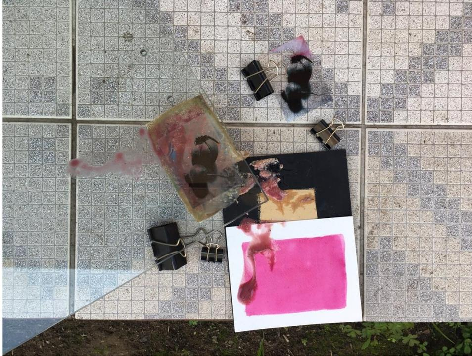
Fig. 54. El biomaterial se dispone como base o papel sensible para el traspaso de la fotografía. Se esperaba realizar una larga exposición al sol en primavera, sin embargo, no soporta el calor y a los 45 minutos se derrite por completo.
