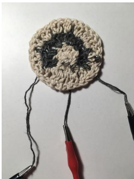
Fig. 18. Potenciómetro tejido con virutilla y pita. Registro personal.
